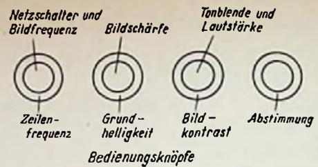
Bild 3. Die Anordnung der Bedienungsknöpfe
