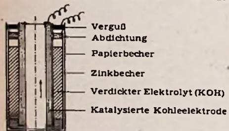
Bild 2. Schnitt durch die neue Trockenzelle
