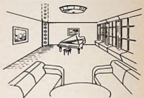
Bild 18. Besonders günstige Anordnung einer Schallzelle in einem Innenraum. Die beim Schwingsystem benachbarten Wände sollen glatt und gut reflektierend, die gegenüberliegende Raumecke soll gedämpft sein (Polstermöbel)
