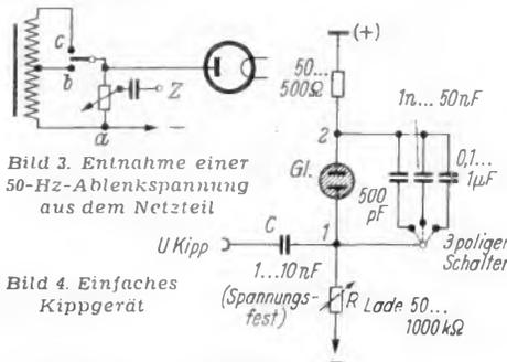
Bild 3. Entnahme einer 50-Hz-Ablenkspannung aus dem Netzteil
