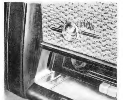
Bild 5. Chassis-Gleitschiene am Boden eines Tonfunk-Empfängers
