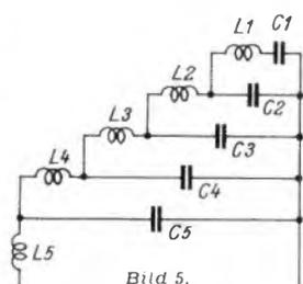
**Bild 5.** Aus Bild 4 abgeleitetes vereinfachtes Ersatzschaltbild
