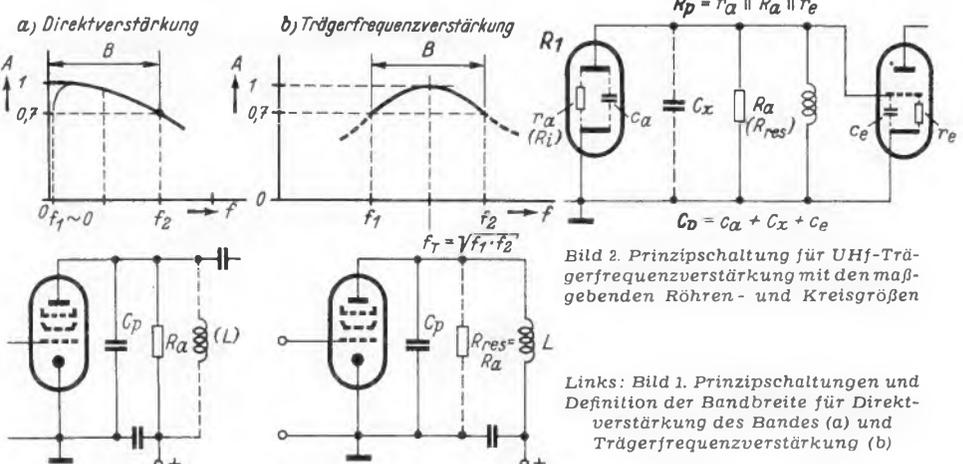
Bild 2. Prinzipschaltung für UHF-Trägerfrequenzverstärkung mit den maßgebenden Röhren- und Kreisgrößen
