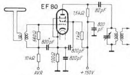
Bild 40. Eingangsstufe eines Fernsehempfängers in Pentodenschaltung
