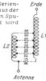
einer (großen) Kapazität mit einer (kleinen) Selbstinduktion vereinfacht. Kondensatormessungen bei 0,6 und 2 MHz ergaben Induktivitäten von einigen Zehnieln µH. Kapazitätswerte von 500 pF zeigten Serienresonanzen um 12 MHz, während bei Kopplungskondensatoren von etwa 100 pF die Resonanzen über 30 MHz lagen. Bei normalen Rundfunkfrequenzen sind demnach die Elektrodeninduktivitäten vernachlässigbar klein.
