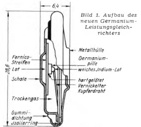
**Bild 1.** Aufbau des neuen Germanium-Leistungsgleichrichters
