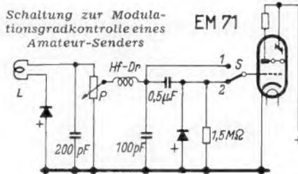
ein mittlerer Modulationsgrad von höchstens 85 bis 90% vorhanden ist, damit in den Modulationsspitzen keine Übermodulation verursacht wird.
