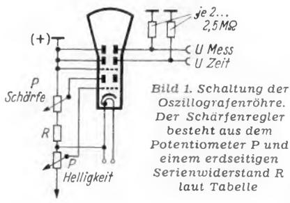
Bild 1. Schaltung der Oszillografenröhre. Der Schärfe- und Helligkeitsregler besteht aus dem Potentiometer P und einem erdseitigen Serienwiderstand R laut Tabelle
