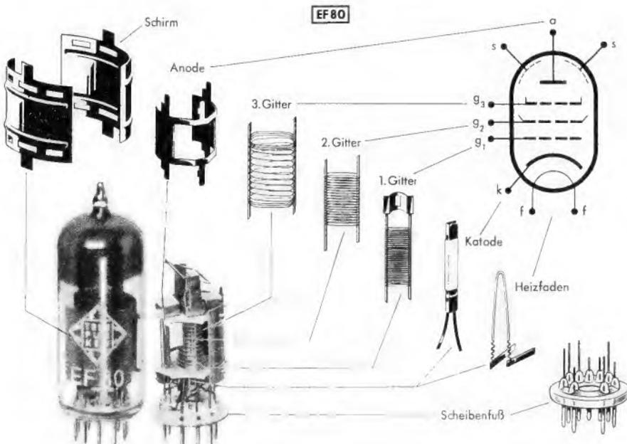
Bild 6. Systemaufbau der modernen UHF-Breitbandpentode EF 80 (Telefunken)
