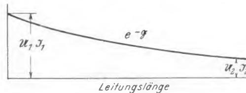
Die Dämpfung auf einer Doppelleitung (Paralleldraht- oder konzentrische Leitung) ist gegeben durch:
