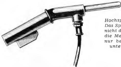
Hochspannungsprüfspitze. Das Spannungskabel führt nicht durch den Handgriff, die Metallspitze erscheint nur beim Druck auf den unten am Griff befindlichen Keil
