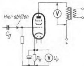
Die Anodenstromänderung bei Ablöten eines schadhafte Kopplungskondensators kann durch Messen des Spannungsabfalles am Kathodenwiderstand oder am Ausgangsübertrager beobachtet werden
