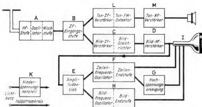
Empfänger für die europäische Fernsehnorm werden fast ausnahmslos nach dem Überlagerungsprinzip aufgebaut. Sie bestehen dann nach dem Blockschaltbild aus folgenden Baugruppen:
