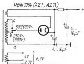
Bild 2. Netzgerät mit umschaltbarer Anodenspannung
