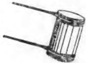
nach DIN 41 161 Klasse 1, dichte Ausführung im keramischen Rohr mit aufgelöteten Metallkappen.
