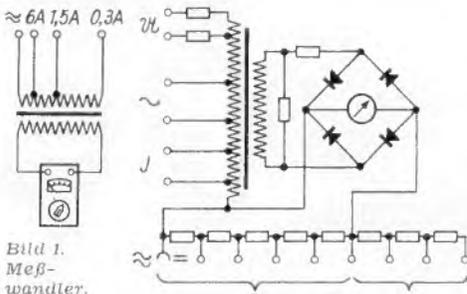
Bild 1. Meßwandler, um bei Strommessungen mit einem Vielfachinstrument niedrigen Innenwiderstand zu erzielen
