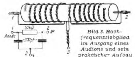
Widerstand mit zwei Bündelkondensatoren
