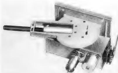
Die Ferritstabantenne wird in drei Ausführungen geliefert. Ausführung I zum Preis von 18,50 DM dient zum Einbau in die neuen Grundig-Geräte 3010 und 3012. Für die Geräte 4010 und 5010 wurde die Antenne mit einer aperiodischen Breitbandverstärkerstufe unter Verwendung der Röhre EF 42 zusammengebaut (Bild), wobei die Röhre aus dem Netz-
