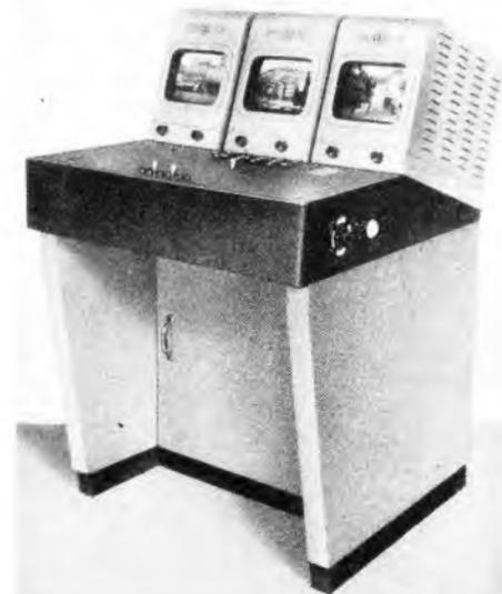
Bild 6. Mischpult zur Auswahl bzw. Mischung und Überblendung der von verschiedenen Aufnahme geräten angelieferten Fernseh-Bildsignale
