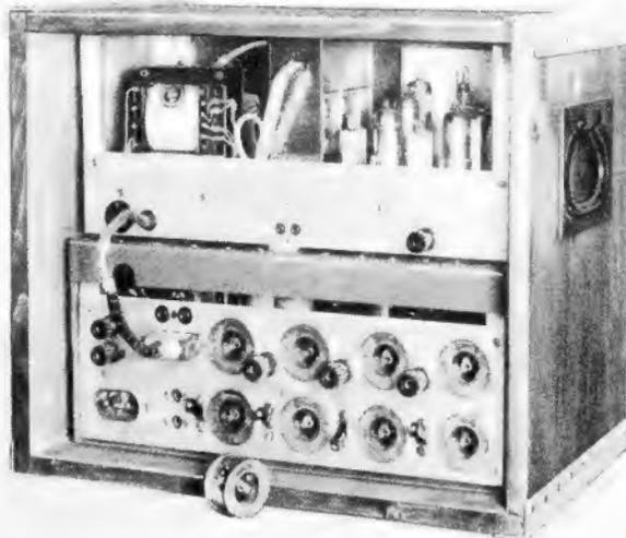
Rechts Bild 8. Chassis-Aufsicht. Am Netztransformator ist ein Sicherungselement mittels eines Winkelblechs angebracht
