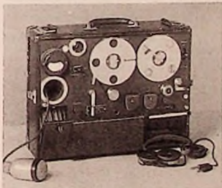
Reportage-Tonbandgerät C des Bayerischen Rundfunks (19 cm Bandgeschwindigkeit) Aufnahme: E. Anker
