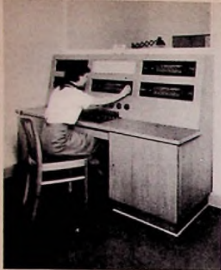
Bild 1. Zentralgesteuerte Rundfunkübertragungsanlage mit fünf Rundfunkempfängern und Zehnplattenspieler
