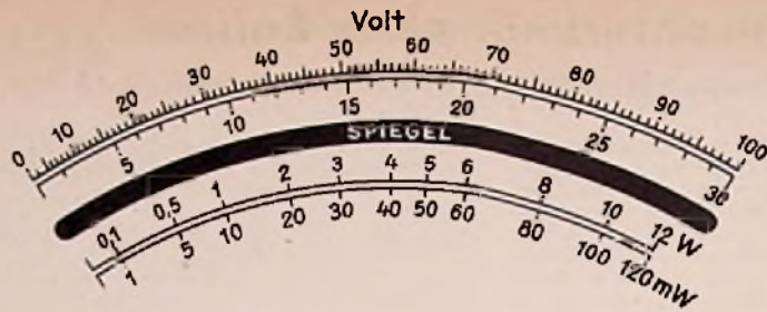
Bild 3. Skalenteilungen des Röhrenvoltmeters
