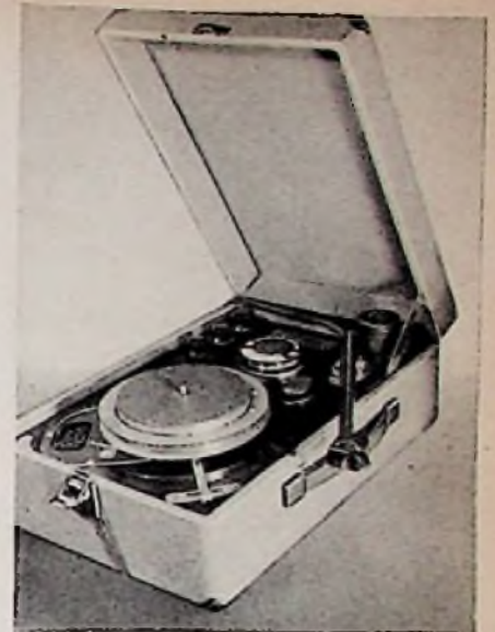
Kofferausführung des Drahttongerätes mit zwei Motoren u. auskuppelbarem Plattenteller
