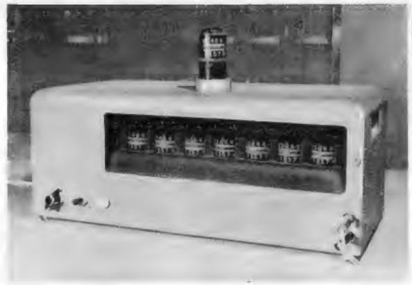
Bild 9. Zählgerät mit Valvo-Zählröhren E 1 T
