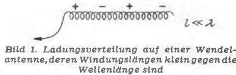
Bild 1. Ladungsverteilung auf einer Wendelantenne, deren Windungslängen klein gegen die Wellenlänge sind
