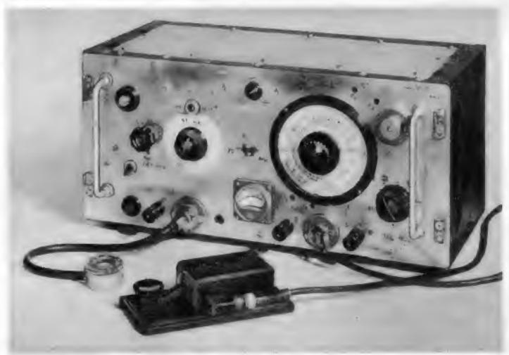
Unterhalb der Skala befindet sich der Anschluß für die Morsetaste und links neben dem Meßinstrument der Ausgangsanschluß des Steuersenders. Über diesem Hf-Steckanschluß (Evertz-Kupplung) erkennt man den Drehknopf von C 20 und den zugehörigen Spulen-Umschalter S 1. Der am weitesten links angebrachte geriffelte Knopf gehört zum Potentiometer R 14, mit dem die Ausgangsspannung (Steuerleistung) eingestellt werden kann.
