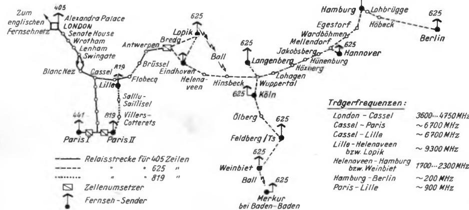
Bild 1. Die große Fernsehbrücke
