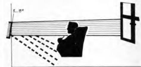
Bild 3. Waagrecht einfallendes Störlight kann durch eine leichte Neigung des Bildschirms unschädlich gemacht werden
