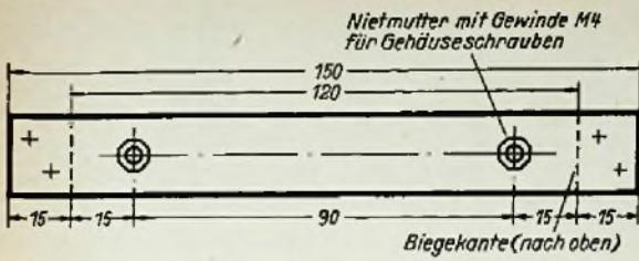
Bild 12. Quersteg (Eisenblech 1,5 mm)
