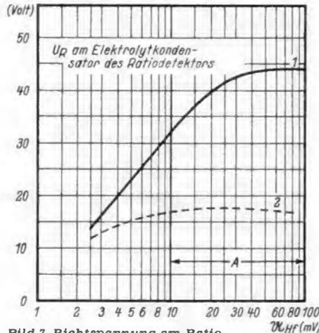
Bild 7. Richtspannung am Ratiodektor. Kurve 1: normale Schaltung mit Bremsgitter an Masse, Kurve 2: Bremsgitter am heißen Ende des Elektrolytkondensators im Ratiodektor (vgl. Bild 9)
