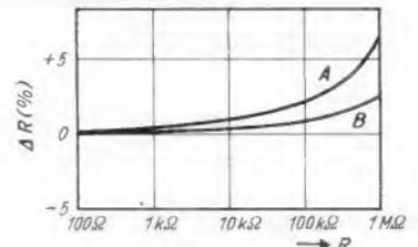
Änderung des Widerstandswertes von Dra-lowid-Schichtwiderständen Typ B nach der Salzwasserprüfung. A =  $0,5\text{-W}$ -Ausführung, lackiert und schlauchisoliert, B = gleiche Ausführung, nicht lackiert und schlauchisoliert
