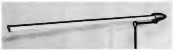
Das „Gewehrmikrofon“, ein Rohrmikrofon mit scharfer Richtwirkung
