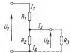
Bild 3. Spannungsteiler, Dimensionierungs-Beispiel
