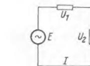
Bild 2. EMK und Spannungsabfälle in einem Stromkreis
