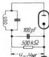
Bild 28. Meßschaltung für die Kurven von Bild 27
