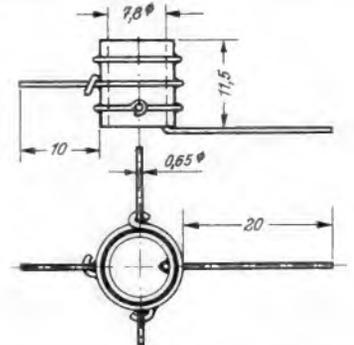
Röhrenfassungs-Kondensator mit  $3 \times 1,5 \text{ nF}$  von Rosenthal; der Kondensator wird unmittelbar zwischen den Anschlußlösen der Röhrenfassung angeordnet und verbindet auf kürzestem Wege die kalten Elektroden mit Erde
