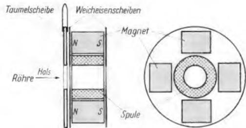
Bild 15. Fokussierung mit Permanentmagneten und zusätzlicher Hilfsspule
