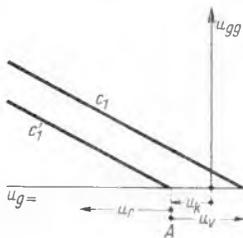
Bild 25. Lage der  $u_{gg}$ -Geraden im Gittergleichspannungsfeld der Regelröhre
