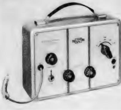
Bild 4. Klirrfaktorbrücke KB 2 des Labor W
