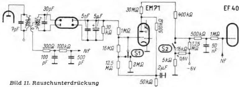
Bild 11. Rauschunterdrückung im Saba-Freiburg W III
