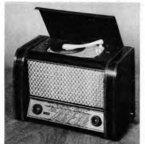
Der kleinste Phonosuper aus deutscher Produktion (Tonfunk „Picophon I“ mit Plattenspieler für 17-cm-Kleinplatten)
