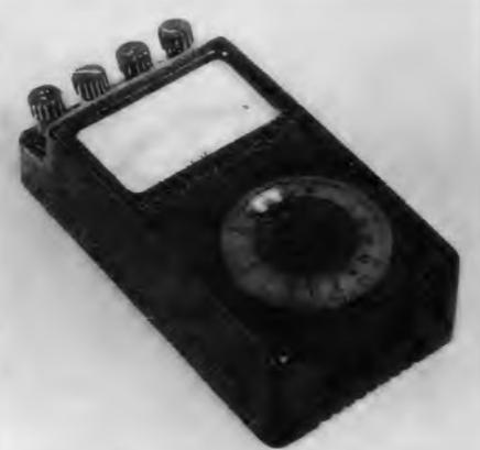
Links: Bild 10. Ontra-Röhrenprüfgerät TRP/4
