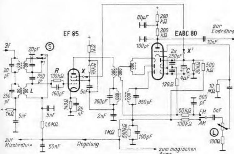
Bild 9. Neuartige Begrenzerschaltung mit Bremsgitterregelung (Nordmende)
