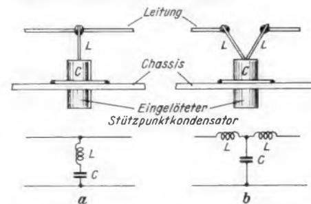
Die Stützpunktkondensatoren von NSF besitzen zwei Lötanschlüsse, um die Wirkung der störenden Selbstinduktion auszuschalten. a = falsche Leitungsentsorgung, L liegt in Reihe mit C, b = richtig, L liegt in Reihe mit der zu entstörenden Leitung
