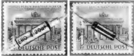
„Miniaturisierung“ von Bauteilen. Links ein „Minitytkondensator“ von Roederstein, rechts eine Entstördrossel der Stemag
