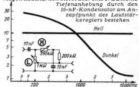
**Tonblende mit Lautstärkegleich bei den Geräten von Kaiser-Radio.** Der normalerweise beim Eindrehen der Tonblende auftretende Lautstärkeverlust wird dadurch ausgeglichen, daß über den dann wirksam werdenden 200-kΩ-Widerstand zusätzlich Spannung vom Eingang zum Ausgang gelangt.
