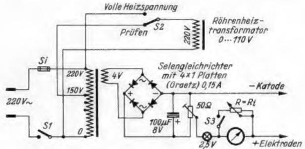
Verbesserter Katodentester. Anstelle einer Zusatzwicklung wird die 150-V-Anzapfung des Netztransformators verwendet. Der Sammler wird durch eine gleichgerichtete Spannung aus dem Netz ersetzt. Das Potentiometer parallel zum Meßinstrument gestattet unmittelbare Ablesungen in: „Gut — Brauchbar — ? — Schlecht“
