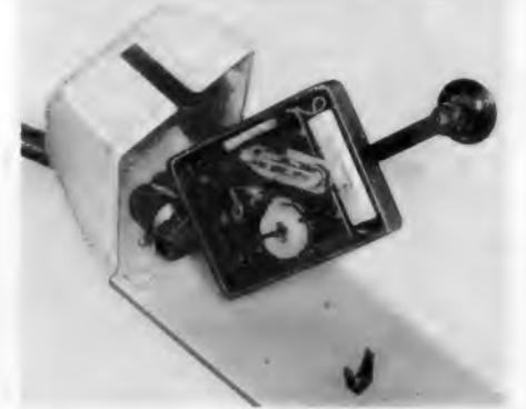
Bild 4. Untenansicht einer mit Taststör-schutz ausgestatteten Handtaste
