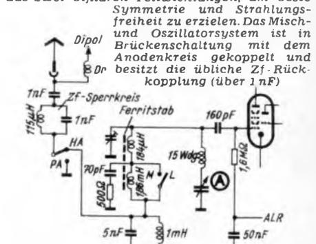
**Eingangsschaltung mit Ferrit-Peilantenne beim Nord-Monde Rigolatto FA.** Die Hochantenne wird über einen Zf-Sperrkreis kapazitiv am Fußpunkt eingekoppelt. Der Eingangskreis wird durch die Wicklung der Ferritantenne gebildet. Ein großer Abstand der beiden Wicklungssteile vermeidet beim MW-Empfang Beeinflussungen durch die kurzgeschlossene LW-Spule. (UKW-Schaltung weggelassen)
