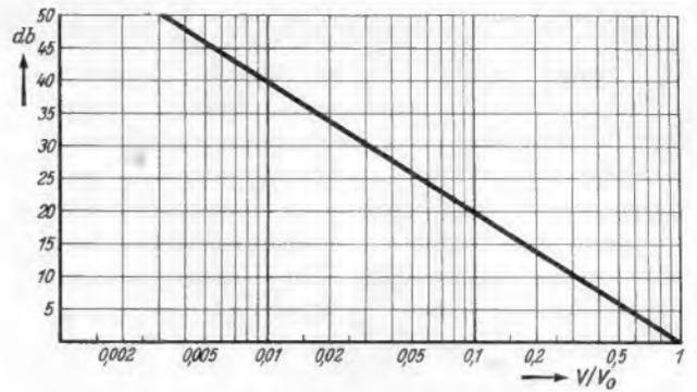
Bild 2. Dämpfung in Dezibel dargestellt in Abhängigkeit vom Spannungsverhältnis  $V/V_0$ .
