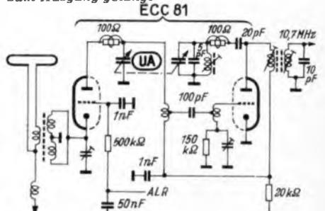
**AM-Antenne UKW-Eingangsschaltung beim Metz 205 W.** Das erste Triodensystem der ECC 81 arbeitet in Gitterbasis-Schaltung mit automatischer Verstärkungsregelung. Die Eingangsschaltung besteht aus zwei bifilaren Teilwicklungen, um beste Symmetrie und Strahlungsfreiheit zu erzielen. Das Misch- und Oszillatorsystem ist in Brückenschaltung mit dem Anodenkreis gekoppelt und besitzt die übliche Zf-Rückkopplung (über 1 nF).
