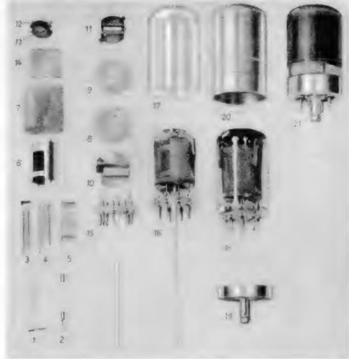
Einzelteile und Aufbau der Röhre C 3 m. 1 = Heizer, 2 = Katode, 3 = 1. Gitter, 4 = 2. Gitter, 5 = 3. Gitter, 6 = Anode, 7 = Abschirmmantel, 8 = untere Glimmerscheibe, 9 = obere Glimmerscheibe, 10 = unteres Abschirmblech, 11 = oberes Abschirmblech, 12 = Halteblech für Gitter, 13 = Gitterpille, 14 = Glimmerfedern, 15 = Preßsteller, 16 = vollständiges System, 17 = Glaskolben, 18 = Röhre gepumpt, 19 = Sockelplatte, 20 = Abschirmhaube, 21 = fertige Röhre
