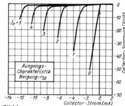
Bild 1. Statische Kennlinien für die Abhängigkeit des Collectorstromes von der Collectorspannung; Emittierstrom  $I_e$  = Parameter, a = Verstärkertransistor TS 13, b = Schalttransistor TS 33
