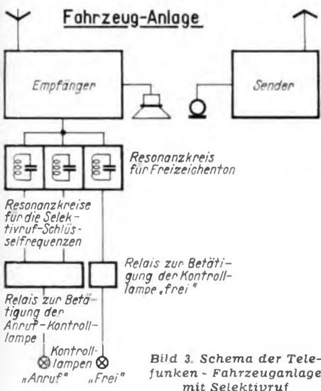
Bild 3. Schema der Telefunken-Fahrzeuganlage mit Selektivruf
