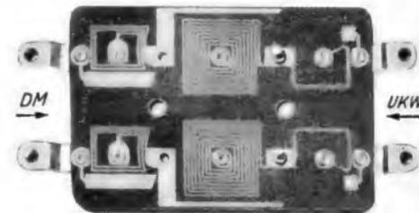
Bild 3. Praktische Ausführung des Trennfilters als gedruckte Schaltung
