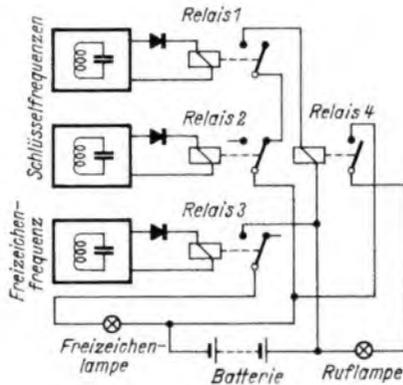
Bild 2. Prinzipschaltung der Relaisanordnung des Rufumsetzers im Fahrzeug
