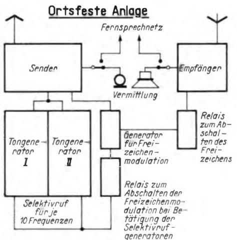
Bild 5. Blockschaltung der ortsfesten Anlage des Selektivrufsystems
