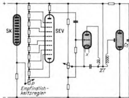
Bild 4. Steuerung eines Blitzgerätes über einen Sekundär-Elektronen-Vervielfacher
