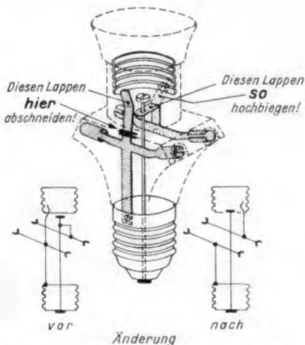
Bild 2. Umbau einer Steckerfassung zum Gebrauch als Vorschaltlampe
