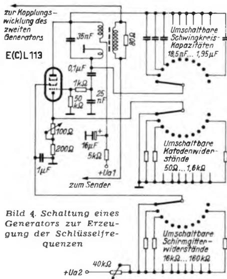
Bild 4. Schaltung eines Generators zur Erzeugung der Schlüsselfrequenzen
