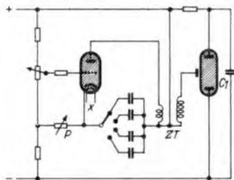
Bild 5. Blitzgerät für periodische Blitzfolgen
