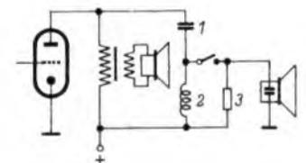
sel 2 (Bild), die bei Hochtonwiedergabe durch den Widerstand 3 bedämpft sind. Bei Normaltonwiedergabe dient die Reihenschaltung 1-2 als 9-kHz-Sperre.
