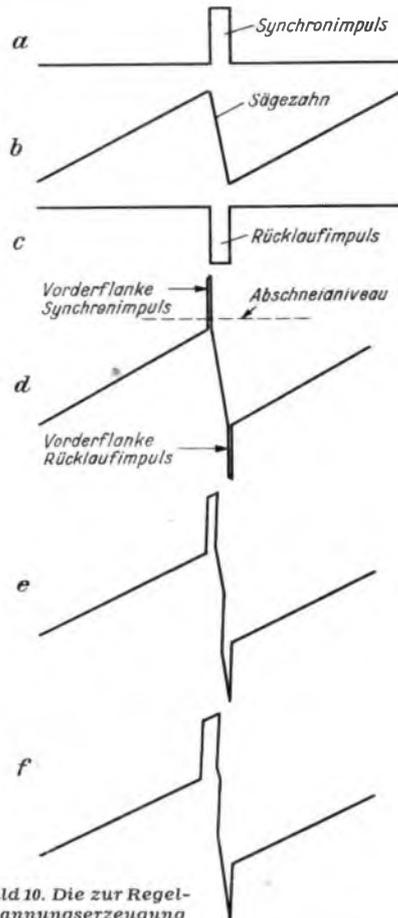
Bild 10. Die zur Regelspannungserzeugung verwendeten Impulse und ihre Addition bei verschiedener Phasenlage zueinander
