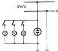
Bild 3. Anordnung mehrerer Vorschaltlampen mit verschiedener Leistungsaufnahme
