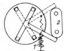
tätig (durch Feder 1, Bild) in die Stellung für die höchste Speisespannung einstellt und erst von dem Einschalter, z. B. dem Gerätestecker 2, in der (gestrichelt gezeichneten) Stellung für geringere Speisespannung festgehalten wird.
