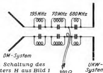
Bild 2. Schaltung des Trennfilters H aus Bild 1
