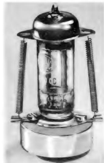
Ösen zum Einhängen der Federn, die zusammen mit der Röhrenfassung auf das Chassis geschraubt oder genietet werden. Die Halterung sichert die Röhre auch bei starken Erschütterungen und Stoßen, z. B. in tragbaren Anlagen, gegen Lockerwerden und Herausfallen. Hersteller: Elektro-Spezial GmbH, Hamburg 1.
