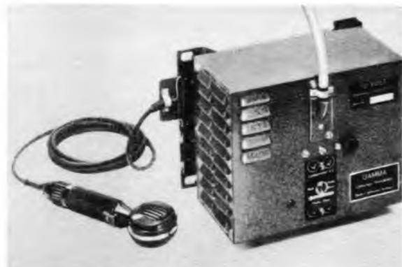
Links: Verstrker- und Mikrofonteil der Omnibus-Anlage „Gamma III“ von Wandel & Goltermann
