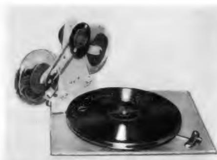
Tonbandaufsetzer zum Plattenspieler hochgeklappt
