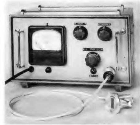
Bild 3. Telefunken-Leistungsmesser 5/600/8000 mW für Wellenlängen von 13 bis 17,65 cm
