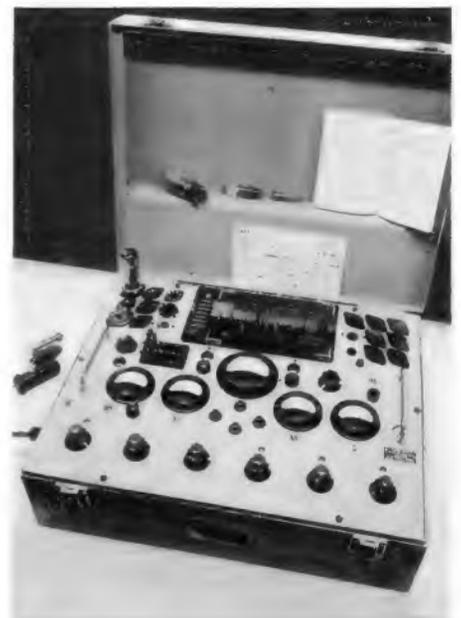
Bild 3. RPM 370/1 Röhren-Prüf-, Meß- und Regeneriergerät
