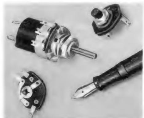
Bild 5. Kleinstpotentiometer und „Trimmer-Widerstände“ der Firma Wilhelm Ruf KG, Hohenbrunn bei München
