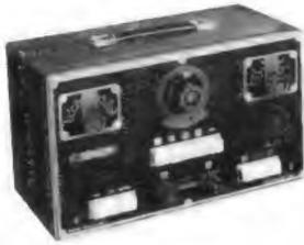
Der konkurrenzlose **TELETEST FS** Service-Sender enthält kombiniert mit Bildmuster-generator und HF-Messender lückenlos und zukunftsicher: Alle FS-Kanäle mit **UKW**-Band einschl. Video-ZF, UKW-ZF und Inter-carrier-ZF, jeweils mit Bild und Ton modulierbar. Bestückt mit 14 Röhren und 2 Dioden. Ausführliche Information durch 36seitige Broschüre „Ratschläge für den Fernseh-Service“ gegen Schutzgebühr DM 1,90. TELETEST 819/625 B umschaltbare Sondertypen für 4 verschiedene Fernsehsysteme.
