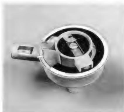
Bild 4. Geöffneter Hf-Regler
