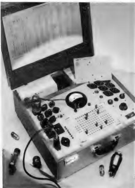
Bild 2. RP 270/1, das Röhrenprüfgerät für den Ladentisch
