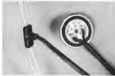
Bild 5. Wetterfest umspritzte Verzweigung eines Transformationsstückes der Fa. Robert Karst und Unterteil des wasserdichten Verbindungsstückes zum Bandkabel. Der eingelegte Gummiring schützt zuverlässig beim Aufpressen des Oberteils gegen Eindringen von Feuchtigkeit
