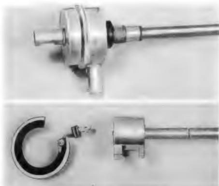
Bild 3. Kohlebahn, abgeschirmter Schleifkontakt und fertiger Hf-Spannungsregler der Firma Preh
