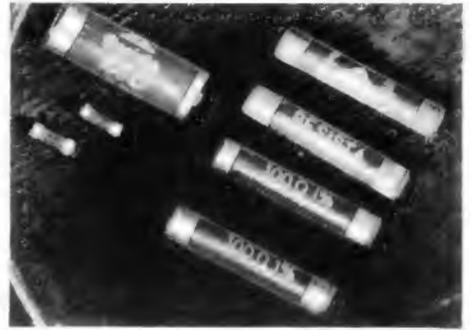
Bild 2. Spezialwiderstände für UKW und Dezi-technik mit versilberten Lötanschlüssen zum direkten Einfügen in den Leitungszug. (Natürliche Größe der Kleinstausführung 1 x 4 mm)
