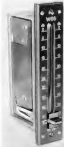
(Der Eingang ist dabei mit  $60 \Omega$  abgeschlossen). Die Grunddämpfung, also die kleinste Spannungsteilung bei voll aufgedrehtem Regler, beträgt 6 db (2:1), die Gesamtdämpfung 80 db (10000:1) bei einem Generator- und Abschlußwiderstand von je  $60 \Omega$ . Der Regler ist mit 0,1 W belastbar (bei  $+ 60^\circ \text{C}$  max. Umgebungstemperatur), die Eingangsspannung darf daher
