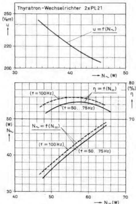
Bild 7. Spannungs- und Leistungsdiagramme des Wechselrichters nach Bild 3
