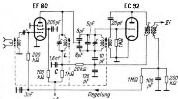
Bild 5. UKW-Eingang mit Röhre EF 80 und Dreifach-Variometer (Saba)
