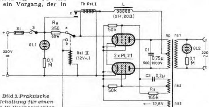
Bild 3. Praktische Schaltung für einen 30-W-Wechselrichter
