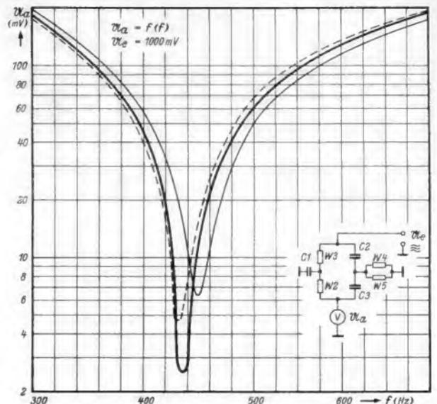
Bild 1. Resonanzkurven eines Doppel-T-Gliedes. — Sämtliche Widerstände und Kondensatoren sind unter sich auf  $\pm 1\%$  gleich. — Der Wert von C3 wurde um 4% vergrößert; die Resonanz verschiebt sich zu tieferen Werten, die Güte des Gliedes sinkt. — Der Wert von W3 wurde um 6,5% verkleinert; neben der Verstimmung zu höheren Frequenzen tritt eine größere Dämpfung ein. Für genaue Messungen sind daher fest eingestellte Brücken mit genau abgeglichenen Einzelteilen zu bevorzugen
