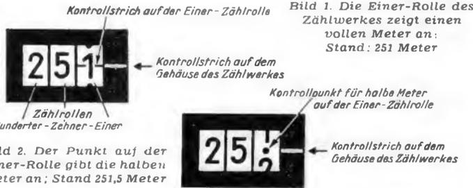
Bild 2. Der Punkt auf der Einer-Rolle der Zählrolle gibt die halben Meter an; Stand 251,5 Meter
