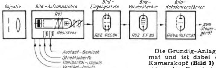
Bild 3. Blockschaltbild des Kamerakopfes
