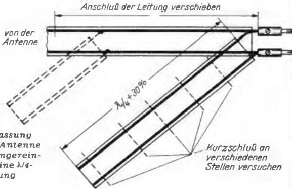
Genauere Anpassung einer Fernseh-Antenne an den Empfängereingang durch eine  $\lambda/4$ -Stichleitung
