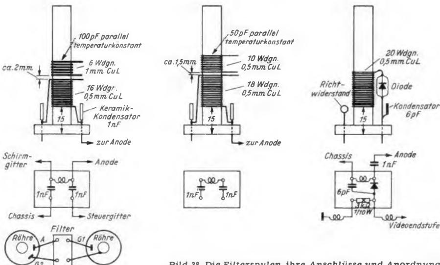
Bild 38. Die Filterspulen, ihre Anschlüsse und Anordnung
