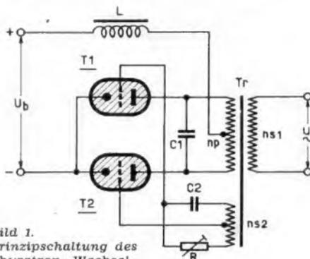
Bild 1. Prinzipschaltung des Thyatron-Wechselrichters
