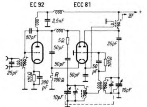
Bild 6. Cascade im UKW-Eingang (Grundig)
