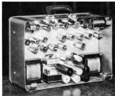
Bild 2. Innenansicht des Steuergerätes
