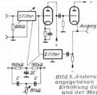
Bild 3. Änderung der in Bild 1 angegebenen Schaltung zur Erhöhung der Selektivität und der Meßgenauigkeit
