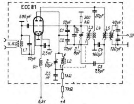
Bild 4. UKW-Eingang mit Gitterbasisstufe (Telefunken)
