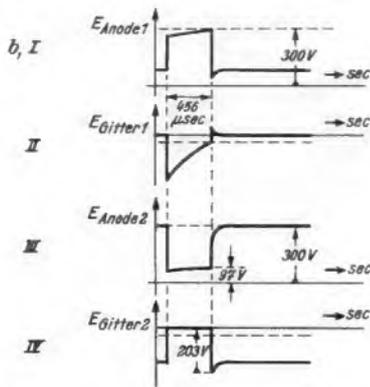
Vorspannung erhält, die höher sein muß als die Sperrspannung dieser Röhre. Die andere Röhre Rö 1 hat dann in der stabilen Phase der Schaltung vollen Anodenstrom.
