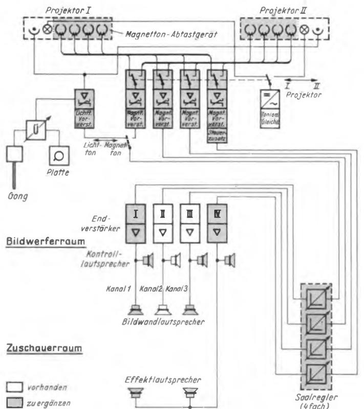
Bild 8. Skizze der Vierkanal-Stereophonie-Tonausrüstung eines Lichtspielhauses (mit Geräten der Telefunken „Cinevox“-Reihe)
