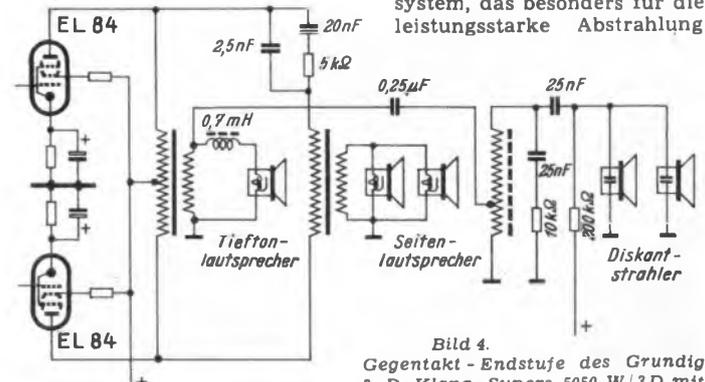
Bild 4. Gegentakt-Endstufe des Grundig 3-D-Klang-Supers 5050 W/3 D mit Klangweichen und fünf Lautsprechersystemen
