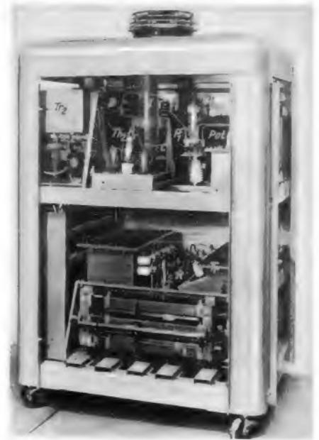
Bild 5. Ansicht des Modulators für den 15-MeV-Beschleuniger. Die Bezeichnungen stimmen mit denen des Bildes 3 überein
