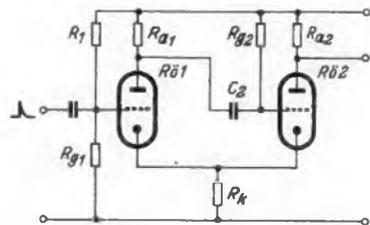
Bild 15. Andere Ausführungsform eines katodengekoppelten Univibrators. Durch eine positive Gittervorspannung, die mit Hilfe der Widerstände  $R_1$  und  $R_2$  eingestellt werden kann, läßt sich die Impulsdauer stufenlos einregeln (elektronische Zeitverzögerungsschaltung)
