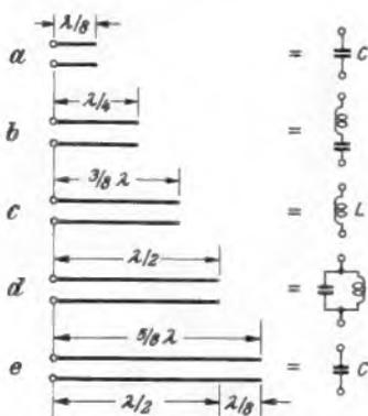
Bild 23. Impedanzen von offenen Leitungsstücken verschiedener Länge
