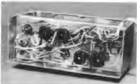
Bild 4. Unterseite des Chassis (Bodenblech und Rückwand abgenommen)
