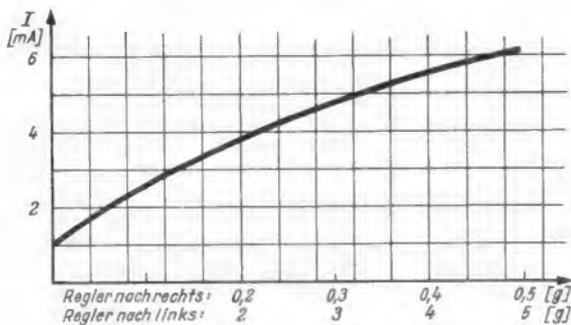
Bild 3. Eichkurve des Mikromanometers (Abszissentteilung für beide Endstellungen des Empfindlichkeitsreglers angegeben)
