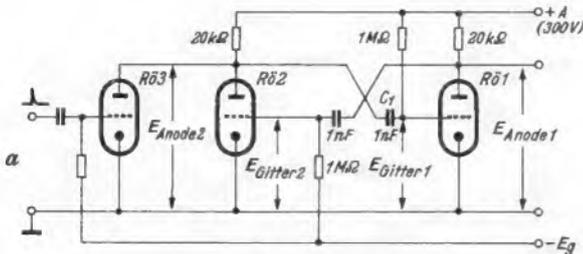
Bild 13. Schaltung eines Univibrators und dazugehörige Spannungskurve. Der positive Startimpuls löst eine vollständige Schwingung der Schaltung aus, die daraufhin wieder in ihren stabilen Zustand zurückkehrt und erst durch einen weiteren Startimpuls in Tätigkeit tritt
