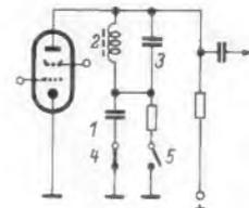
Beim Öffnen von Kontakt 4 und Schließen von 5 dient der Kreis 2-3 zur Höhenanhebung
