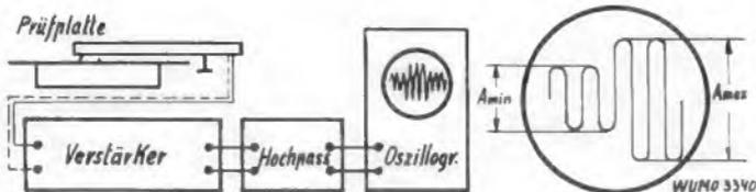
Eine mit ausreichender Genauigkeit arbeitende Meßanordnung ist oben dargestellt. Als Prüfplatte kann DGG 99006 verwendet werden. Die Verzerrungen werden als das prozentuale Verhältnis der auf dem Oszillographenschirm gemessenen Schwingungsamplituden angegeben.
