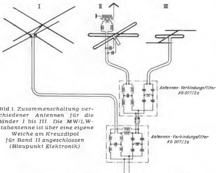
Bild 1. Zusammenschaltung verschiedener Antennen für die Bänder I bis III. Die MW/LW-Stabantenne ist über eine eigene Weiche am Kreuzdipol für Band II angeschlossen (Blaupunkt Elektronik)
