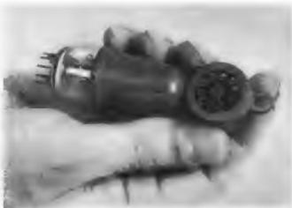
gestellten Röhrenheber. Aus schmiegsamen Gummi gearbeitet, legt er sich fest an die Röhrenwandung an. Im Oberteil sind außerdem zwei Sockeljustierlehren für moderne 7- und 9-Stiftsockel untergebracht, mit denen verbogene Sockelstifte ausgerichtet werden können. Dabei kostet dieses praktische Mehrzweck-Hilfsmittel nur 2.55 DM. Vertrieb: Intraco GmbH, München und Hamburg.
