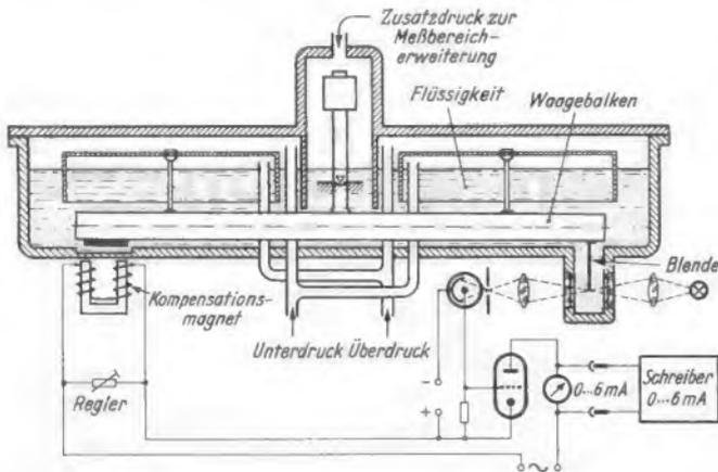
Bild 2. Ansicht des geöffneten Mikromanometers der Visomat-Geräte GmbH
