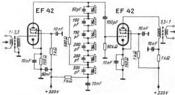
Bild 4. Schaltbild des Kurzwellenkanals aus Bild 2
