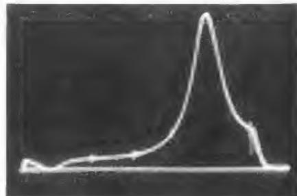
Bild 68. Frequenzkurve gemessen ohne Vorwiderstand von 6 k $\Omega$
