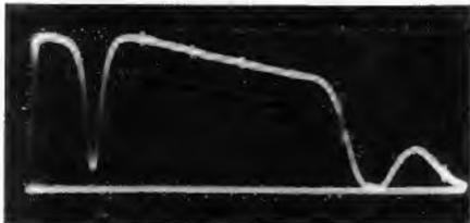
Bild 72. Frequenzkurve mit 6 kΩ ohne Kathodenkondensator
