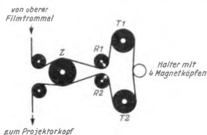
Bild 6. Führung des Vierkanal-Magnettonfilms in einem englischen Magnettonzusatzgerät (Z = Zahnkrantzrommel, R 1 und R 2 = federgepannte Führungsrollen, T 1 und T 2 = Führungsrollen mit schweren Schwungrädern auf den Achsen)
