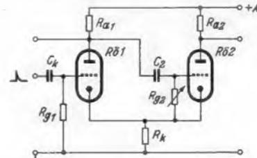
Bild 14. Katodengekoppelter Univibrator
