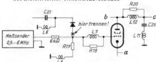
Bild 65b. Anordnung zur Messung des Frequenzgangs des Videoteils. Ausführliche Schaltung s. Bild 41, FUNKSCHAU 1954, Heft 10, Seite 203
