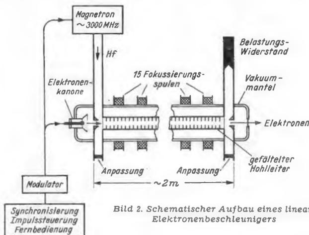
Bild 2. Schematischer Aufbau eines linearen Elektronenbeschleunigers
