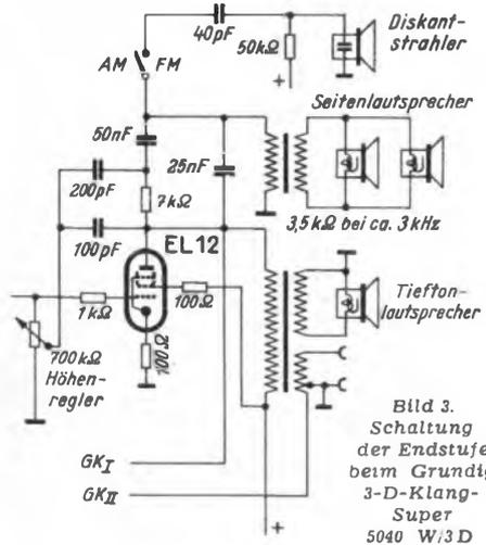
Bild 3. Schaltung der Endstufe beim Grundig 3-D-Klang-Super 5040 W/3 D
