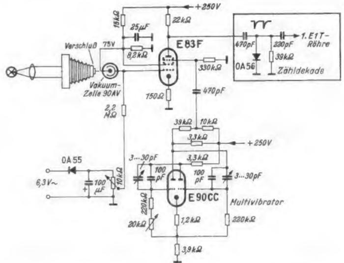
Schema einer Meßeinrichtung für direkte Anzeige von Kameraverschlusszeiten durch eine Zähldekade
