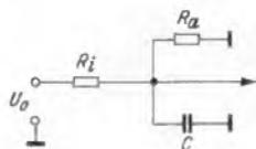
Bild 64. Zur Betrachtung des Generatorwiderstandes am Bildgleichrichter
