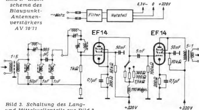
Bild 3. Schaltung des Lang- und Mittelwellenteils aus Bild 2
