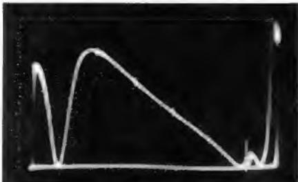
Bild 71. Frequenzkurve am Amplitudensieb mit Vorwiderstand von 6 kΩ
