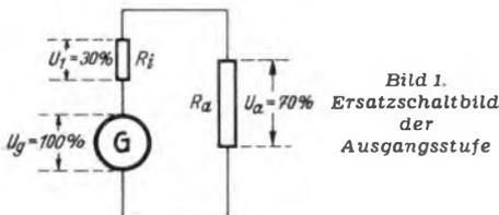
Bild 1. Ersatzschaltbild der Ausgangsstufe
