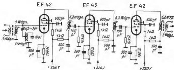
Bild 5. UKW-Verstärkerkanal des in Bild 2 dargestellten Antennenverstärkers
