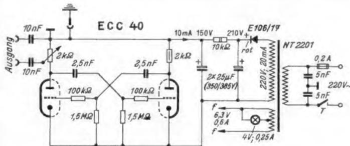
Bild 2. Schaltung des Breitband-Multivibrators
