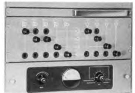
Bild 7. Schaltbildartiger Aufbau des Klinkenfeldes im Stereodyn-Ergänzungsgestell (Klangfilm)
