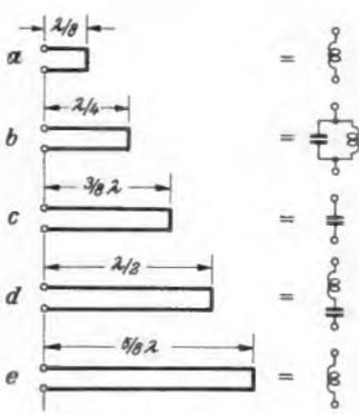
Bild 24. Impedanzen von kurzgeschlossenen Leitungsstücken verschiedener Länge
