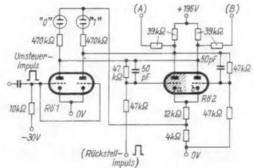
Bild 18. Zählwerk für eine Stelle einer binären Zahl (Modulo-2-Zähler). Mit den Glühlampen wird „0“ oder „1“ angezeigt. Durch einen zweiten Anschluß kann der Zähler auf „0“ gestellt werden
