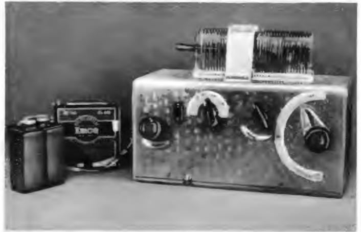
Die additive Mischung ergibt sich aus der Verwendung von Pentoden. Die Tonfrequenz wird mit einem Audion aus der Zwischenfrequenz gewonnen. Die einstufige Nf-Verstärkung reicht für Kopfhörerbetrieb völlig aus.
