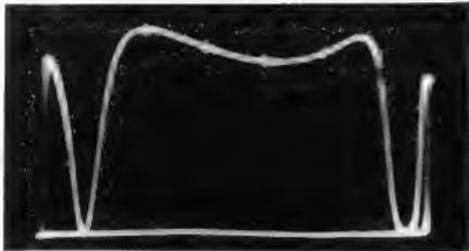
Bild 70. Frequenzkurve mit 10-kΩ-Vorwiderstand
