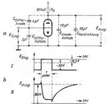
Bild 25. Impulsverzerrung durch Röhren- und Schaltkapazitäten
