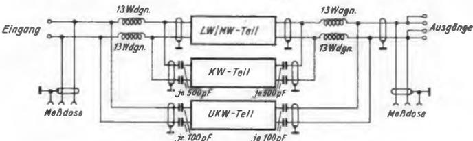
Bild 2. Blockschema des Blaupunkt-Antennenverstärkers AV 70/71
