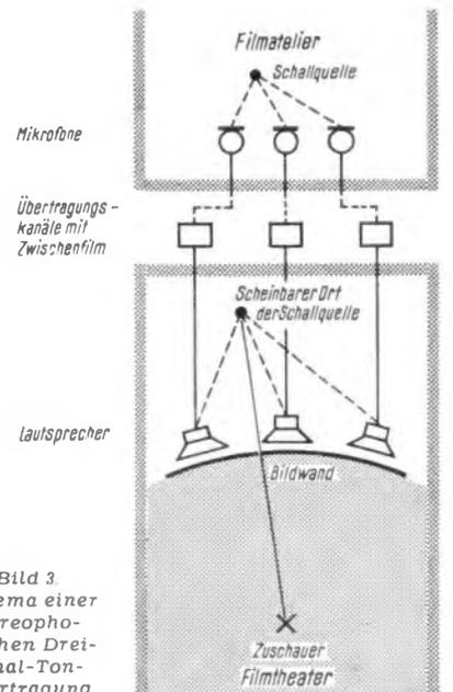
Bild 3. Schema einer stereophonen Dreikanal-Tonübertragung
