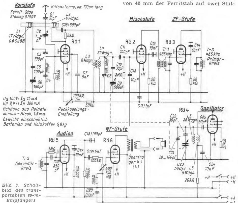
Bild 3. Schaltbild des transportablen 80-m-Empfängers
