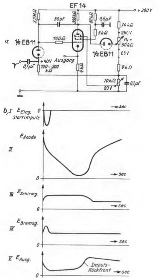
Bild 24. Phantastron-Schaltung, auf der Grundlage des Miller-Integrators
