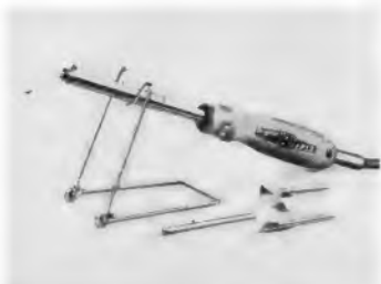
50-W-LötKolben der Firma Ersä mit praktischem Ständer und verschiedenen Lötspitzen
