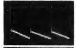
Bild 102. Spannung am heißen Ende der Vertikal-Ablenkspulen
