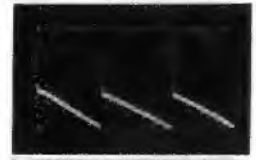
Bild 101. Sägezahnspannung mit Rücklaufspitze an der Anode der Röhre R 17
