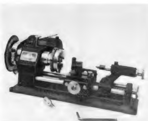
Bild 1. Kleinwerkzeugmaschine Emco-Unimat bei der Verwendung als Drehbank mit Dreibacken-futter, Support und Reitstock
