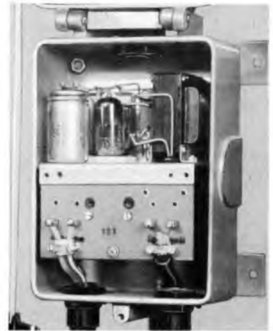
Bild 3. Der ferngespeiste Fernseh-Antennenverstärker AV 100 in seinem wasserdichten Gehäuse
