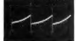
Bild 104. Spannung an Punkt 7 des Vertikal-Transformators
