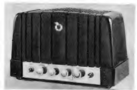
Bild 4. Verstärker mit einschiebbarem Mischteil
