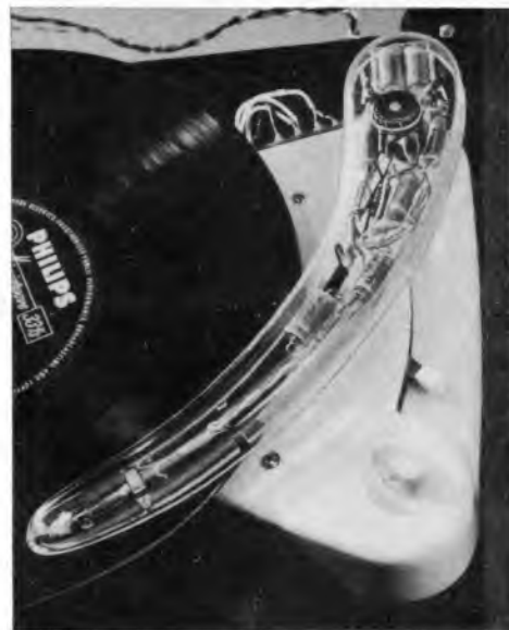
Bild 1. Tonabnehmer mit eingebautem Transistoren-Verstärker (Philips-Electronic-Application-Labor, Zürich/Schweiz)
