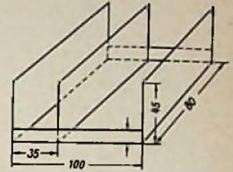
Bild 2. Abmessungen des Chassis
