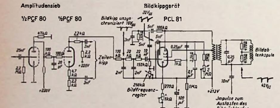
Bild 7. Amplitudensieb und Bildkippergerät im Nora F 1217 T
