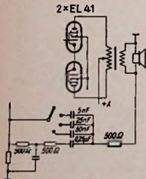
Durch Einfügen des stark gezeichneten  $500\text{-}\Omega$ -Widerstandes wurde die Schwingneigung der Gegenkopplung beseitigt. Der Wert dieses Widerstandes ist von Fall zu Fall auszuprobieren. Macht man ihn größer als unbedingt erforderlich, dann wird der Gegenkopplungsgrad verringert und die gewünschte Frequenzabhängigkeit verwischt.
