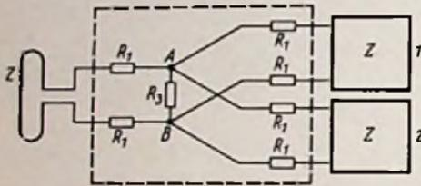
Bild 1. Parallelschaltung zweier UKW-Geräte
