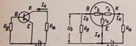
Links: Bild 1. Emitterschaltung eines pnp-Transistors. Rechts: Bild 2. Die inneren Verbindungen zwischen den Elektroden bilden eine Widerstands-Sternschaltung
