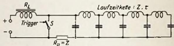
Bild 6. Hochleistungsimpuls-Erzeugungsschaltung
