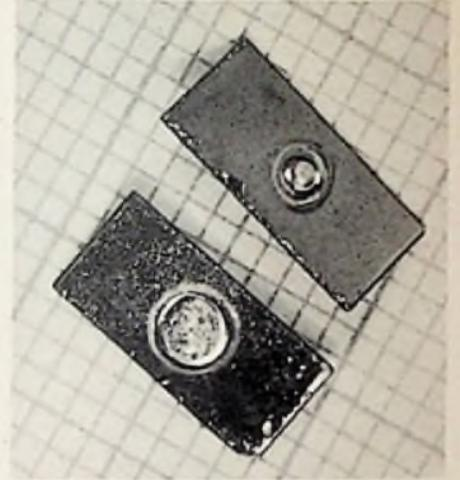
Bild 4. Germanium-Plättchen für einen Transistor. Links die aufgetriggerte Indiumpille für den Kollektor, rechts die Seite mit der Emitterpille. Zwischen Germanium und Indium treten ringförmige pn-Übergänge auf. Untergrund: Millimeterpapier!
