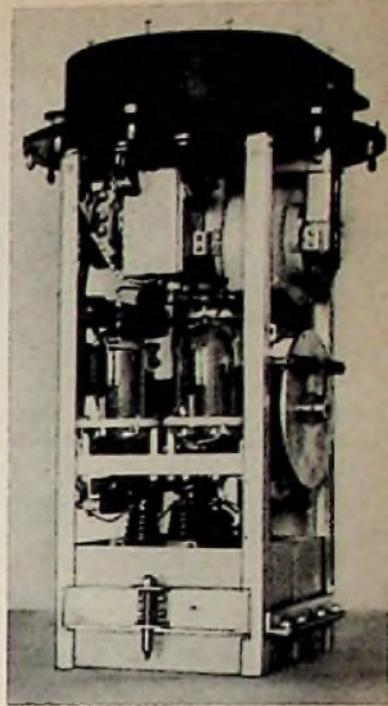
Bild 9. Impuls-generator eines amerikanischen Funkmeßgerätes mit rotierender Funkenstrecke
