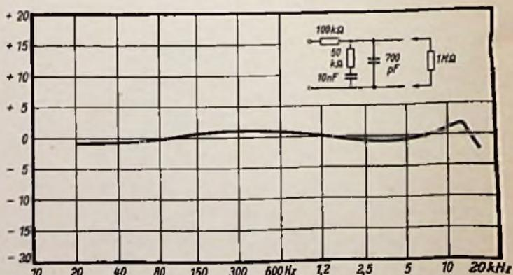
Elac-Kristalltonabnehmersystem KST 9. Frequenzgang für Normalrillen, bezogen auf die Schneidkennlinie 3180/450/50  $\mu\text{m}$  bei Messschallplatten DGG 68 336 B und 68 421;  $0\text{ dB} = 28\text{ mV/cm s}^{-1}$
