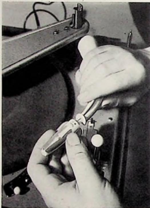
Kaum fingergroß ist der umschaltbare Abtastkopf eines Philips-Phono-Laufwerkes
