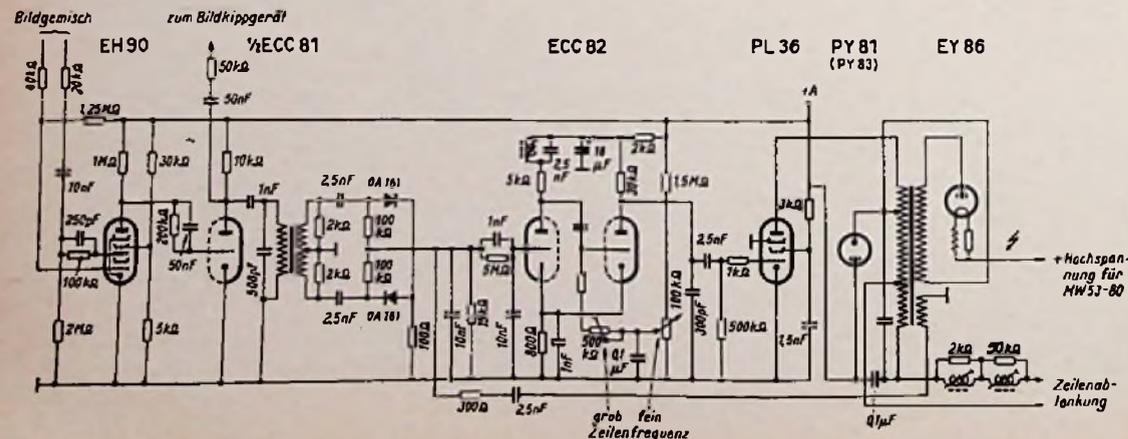
Bild 8. Störausgestastetes Amplitudensieb mit EH 90 und Zeilenablenkteil für 90-Grad-Bildröhre in den neuen Graetz-Modellen
