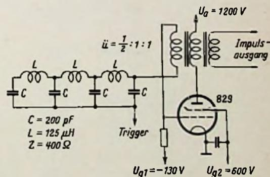
Bild 4. Rückkopplungs-Impulserzeugungsschaltung
