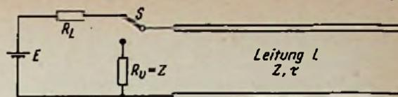
Bild 2. Prinzipschaltung für die Erzeugung von Impulsen
