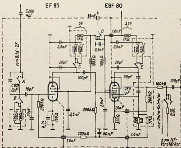
Bild 7. Schaltung des AM-Ton-Zf-Teiles aus dem Viernormen-Zusatz
