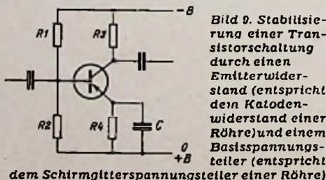
Bild 9. Stabilisierung einer Transistorschaltung durch einen Emittierwiderstand (entspricht dem Katodenwiderstand einer Röhre) und einem Basisspannungsteiler (entspricht dem Schirmgitterspannungsteiler einer Röhre)
