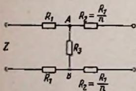
Bild 2. Vierpol-Ersatzschema des Entkopplers nach Bild 1
