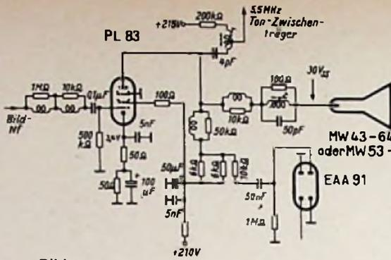
Bild 4. Bildendstufe der neuen Nordmende-Empfänger für automatische Steuerung der Bildhelligkeit
