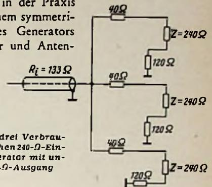
Bild 4. Anschluß von drei Verbrauchern mit symmetrischen  $240\text{-}\Omega$ -Eingängen an einen Generator mit unsymmetrischem  $133\text{-}\Omega$ -Ausgang
