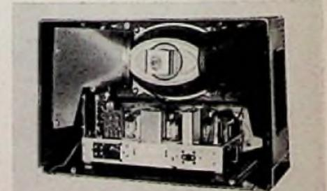
Seitliche Schallführung beim Grundig-1055 W
