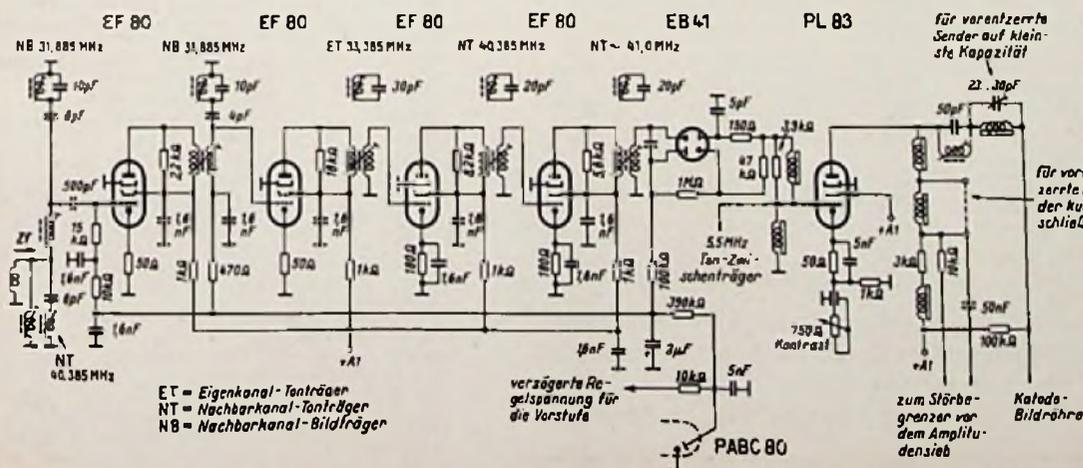
Bild 3. Zwischenfrequenzverstärker, Video-gleichrichter und Bildendstufe im Siemens 543a
