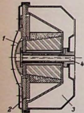
Bild 3. Schnitt durch die Mikrofon-Kapsel der Type D 11.
