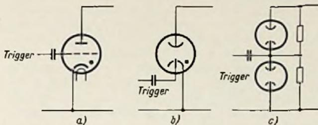
Bild 8. Schaltbilder verschiedener Hochleistungsschaltströhren für Impulsbetrieb; a = Wasserstoffthyratron PL 522 (Valvo); b = Hochdruckstromtor LG 201 (2,5 bis 5 atü Xenon), eine Funkenstreckenröhre mit Hilfszündelektrode; c = Funkenstreckenröhren mit Quecksilber-Eisenschwammkathoden in Serienschaltung,  $2 \times 1 \text{ B } 42$  (Western Electric)
