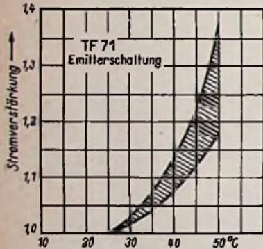
Bild 7. Temperaturabhängigkeit der Stromverstärkung beim Siemens-Transistor TF 71
