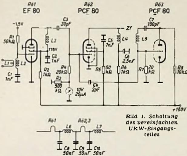
Bild 1. Schaltung des vereinfachten UKW-Eingangsteiles
