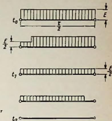
Bild 3. Bestimmung der Impulsdauer
