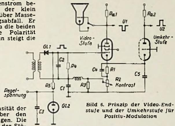
Bild 6. Prinzip der Video-Endstufe und der Umkehrstufe für Positiv-Modulation
