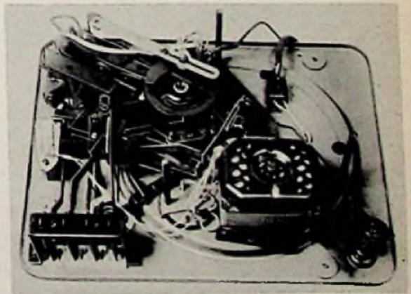
Rechts: Unterseite des Miracord-Wechslers M 8. Die vier Drucktasten unten links wirken rein mechanisch über Hebel auf den Mechanismus
