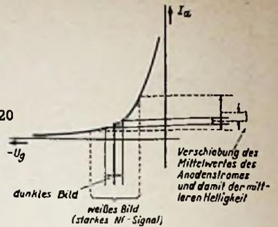
Bild 5.  $I_a/U_g$ -Kennlinie der Röhre PL 83 für die Nordmende-Bildendstufe nach Bild 4
