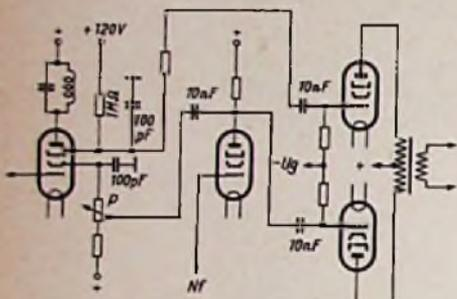
Prinzip einer Phasenumkehrstufe ohne Röhrenaufwand. Die Anodenwechselspannung der Nf-Vorröhre wird dem Schirmgitter der Zf-Röhre zugeführt und um  $180^\circ$  in der Phase gedreht am Bremsgitter wieder abgenommen. Der Regler P dient zum Einstellen gleicher Amplituden.
