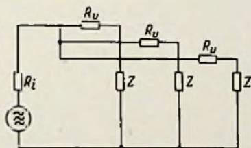
Bild 3. Anschluß mehrerer Verbraucher an einen Generator
