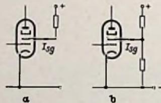
Bild 8. Schirmgitterspannungsversorgung einer Röhre; a) bei Spelzung über einen Vorwiderstand ist die Spannung stark vom Schirmgitterstrom abhängig; b) durch einen Spannungsteiler mit genügend großem Querstrom wird die Schirmgitterspannung festgehalten, auch wenn der eigentliche Strom innerhalb der Röhre sich ändert
