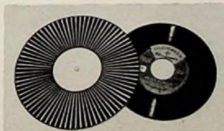
Bild 1. Stroboskopscheibe für 78 Umdr./min. neben einer handelsüblichen Schallplatte
