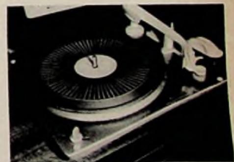
Bild 2. Drehzahlüberprüfung eines auf 78 Umdr./min. geschalteten Plattenwechslers
