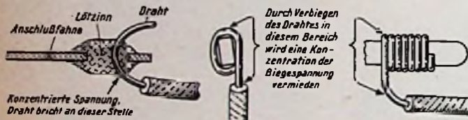
Bild 1. Vergleich einer normalen Lötverbindung (links) mit einem „Drahtwickel“
