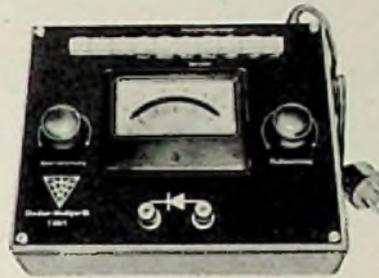
Zur schnellen Aufnahme der statischen Kennlinien von Germanium- und Silizium-Dioden u. Selen- u. Kupferoxydul-Meßgleichrichtern. Fluß- und Sperrspannung getrennt stufenlos regelbar. 10 Drucktasten.
