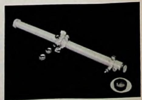
Bild 5. Praktisch ausgeführter Sechsfach-Verteiler nach Bild 4
