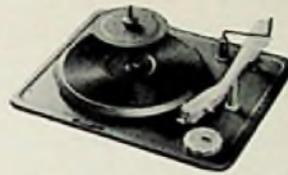
das Spiel sofort. Ein besonderer Vorzug des „Dokamix“ ist der sinnvoll konstruierte Gewichtsausgleich des Tonarmes. Der Auflagedruck von 8 Gramm bleibt stets gleich, und zwar unabhängig von der Zahl der auf dem Plattenteller liegenden Platten. Der Tonarm enthält ein auswechselbares Kristallsystem mit zwei
