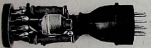
Bild 7. Fertiger Adapter ohne aufgesetzte Röhre ECH 81; Höhe ca. 75 mm
