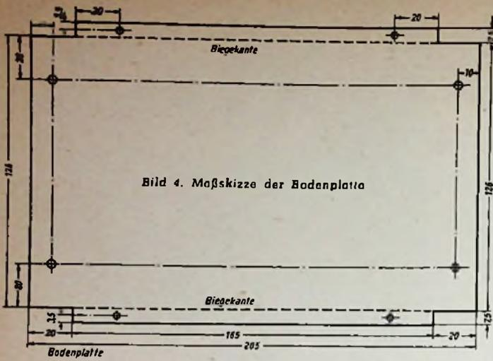
Bild 4. Maßskizze der Bodenplatte
