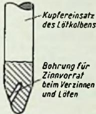
LötKolbenspitze mit Bohrung in der Kolbenschnoida
