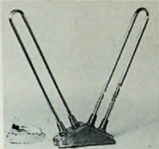
gebracht. Der V-förmig gekrümmte Dipol verbreitert das Empfangsmaximum, so daß auch ohne genaue Ausrichtung in Sendernähe ohne großen Antennenaufwand Empfang möglich ist (Robert Korst, Berlin SW 29).
