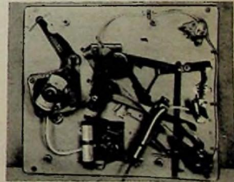
Bild 1. Plattenwechsler „Rex A“ von Perpetuum-Ebner, links Außenansicht, rechts Unterseite
