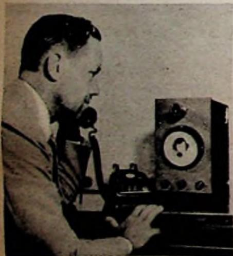
Bild 3. Versuchsaufführung des Bell-Picturephone. Neben dem Fernsprechapparat ist das Labormuster des in Bild 2 (rechte Seite) dargestellten Sichtgerätes einschließlich Kleinkamera und Trommel-speicher zu erkennen
