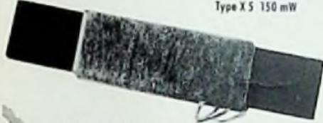
Ferritstab mit Antennenspule Type AL 70 abgestimmt
