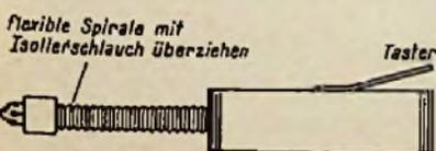
Bild 1. Ein batteriebetriebener Gasanzünder läßt sich durch Einsetzen eines Glühlämpchens zum Durchleuchten gedruckter Schaltungen verwenden
