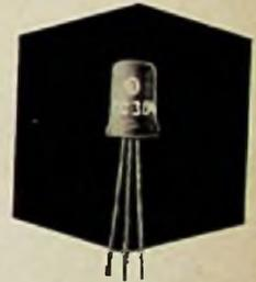
Silizium-Halbleiterbauelemente sind bei Umgebungstemperaturen bis zu +150° C verwendbar.
