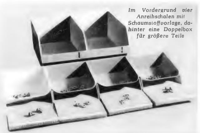
Im Vordergrund vier Anreihschalen mit Schaumstoffvorlage, dahinter eine Doppelbox für größere Teile
