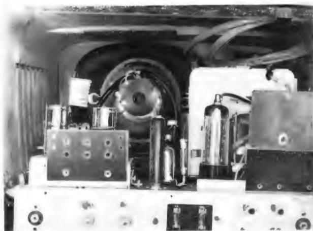
Bild 2. Blick in das Innere des Gerätes; trotz der geringen äußeren Abmessungen ist über den Röhren des Horizontalchassis noch reichlich Raum vorhanden
