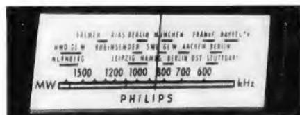
Bild 3. Bedruckte Leuchtplatte als Radioskala
