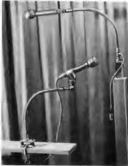
Bild 1. Mikrofon-Schwanenhäse aus flexiblem Schlauch
