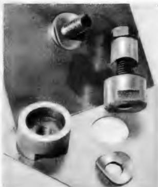
In 1/4 Min. werden mit dem **Rekordlocher** einwandfreie Löcher in Metall und alle Materialien gestanzt. Leichte Handhabung – nur mit gewöhnlichem Schraubenschlüssel. Standardgrößen von 10-61 mm Ø, ab 9.10 DM
