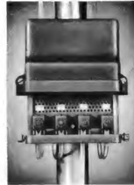
Fuba-Antennenweiche AKW 1000, Einsatz mit den Anschlußklemmen nach unten aus dem Gehäuse herausgezogen
