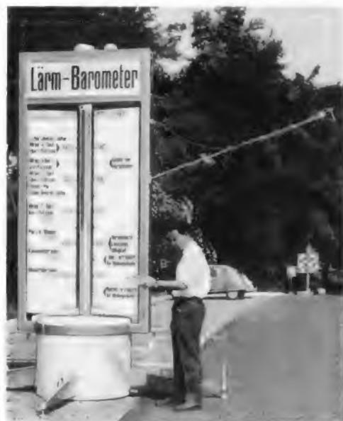
Über 3,5 Meter hoch ist dieses Riesen-Phonometer, das die Firma Honegger Elektronik anlässlich der Lärmbekämpfungswochen für die Stadt Zürich gebaut hat. Es zeigt den Schalldruck von 40 bis 100 dB (gleich DIN-Phon), nachts sind die Plexiglas-Skalen von innen beleuchtet. Eine volltransistorisierte „Elektronik“ steuert ein rotes Nylonband als Anzeigegläser in einem Plexiglasrohr
