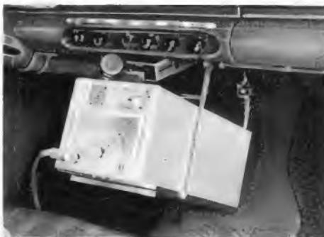
Bild 2. Ein 8-W-Sender für 144 MHz von DJ 5 CK
