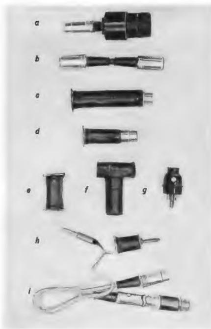
Bild 14. Zwischen- und Übergangsstücke; a = Übergangsstück nach Bild 8, b = Zwischenstück (flexibel) nach Bild 5, c und d = Übergangsstücke nach Bild 3, e = Zwischenstück nach Bild 5, f = T-Verteiler nach Bild 4, g = Fernschaltstecker für Saba-Tonbandgeräte, h = Übergangsstück nach Bild 2, i = Überspielleitung vom Fernseh- oder Rundfunkgerät mit 5...10-Ω-Ausgang auf Tonbandgerät
