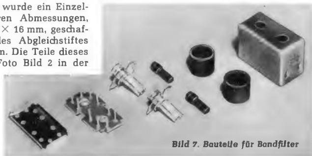
Bild 7. Bauteile für Bandfilter
