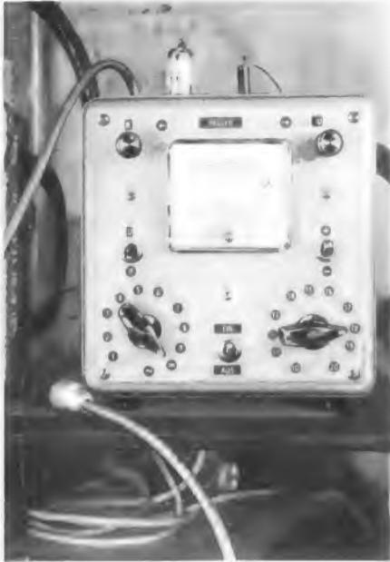
Bild 4. Mit diesem Gerät werden im neuen Empfänger die Werte für die Adaptermessungen aufgenommen
