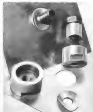
In 1 1/2 Min. werden mit dem Rekordlocher einwandfreie Löcher in Metall und alle Materialien gestanzt. Leichte Handhabung - nur mit gewöhnlichem Schraubenschlüssel. Standardgrößen von 10-61 mm  $\varnothing$ , ab 9.10 DM
