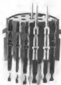
Bild 2. Isolierteil der KPT-Steckverbindungen mit einigen eingesetzten Kontakten
