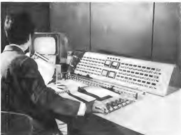
Bild 3. Zentrales Ansagestudio mit Beobachtungsgerät für die optische Nachrichtenübermittlung im Flughafen. Vorn rechts die „Prioritätsschalter“ zum Aufschalten aller zeitweilig abgetrennten Teile der Lautsprecheranlage auf diese Zentrale (Foto: Jean Mainbourg, Paris)
