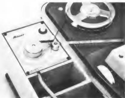
Bild 9. Bauer-Tonkoppler am Tonbandgerät. Die Tonrolle kann für zwei Bandgeschwindigkeiten ausgewechselt werden
