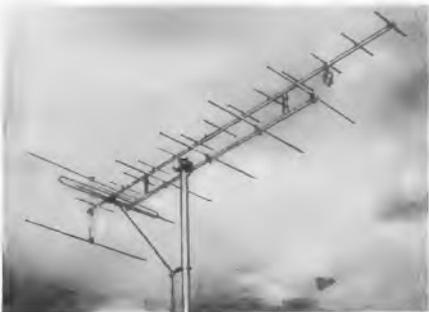
Bild 2. Kombinationsantenne mit 23 Elementen in zwei Ebenen zum Empfang je eines Senders in den Fernsehbereichen III und IV/V aus annähernd gleichen Richtungen
