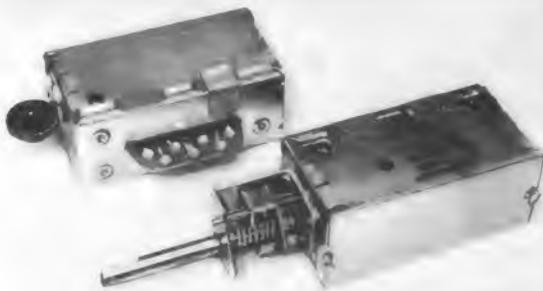
Bild 1. Görler-Transistor-UKW-Bausteine vom Typ UT 4. Links Ausführung mit Seilzug, rechts mit Spindeltrieb
