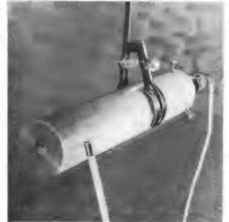
Bild 3. Modellkörper zum Bestimmen des äußeren Schallfeldes
