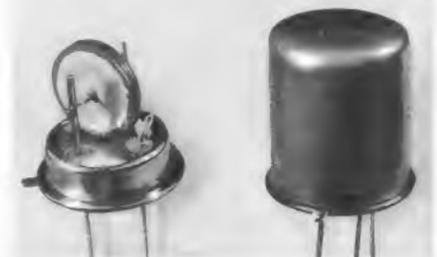
Bild 16. Äußerer Aufbau des Vierpolfilters, links der Sockel mit dem System, rechts das gepackelte Filter
