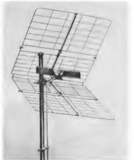
Bild 5. Mehrbereich-Corner-Antenne für alle Kanäle der Fernsehbereiche IV/V
