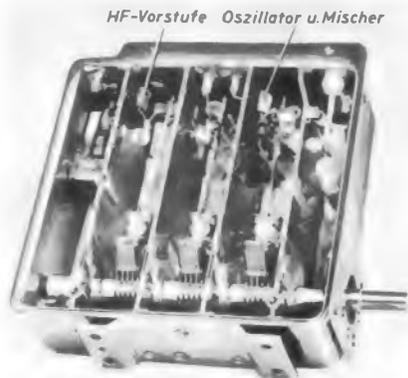
Bild 1. UHF-Tuner mit zwei Mesa-Transistoren, geöffnet (Blaupunkt)
