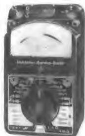
Ein Prüfgerät für Transistoren
