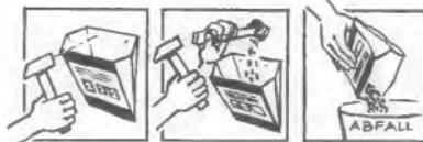
Bild 7. Eine Papiertüte, die man an die Wand heftet, fängt bei Stemmarbeiten den Schmutz auf (Kathrein)
