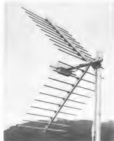
Bild 3. Cornerreflektor für Bereich IV (Fuba)
