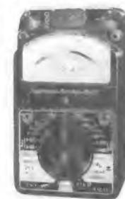
Ein Prüfgerät für Transistoren aller Art
