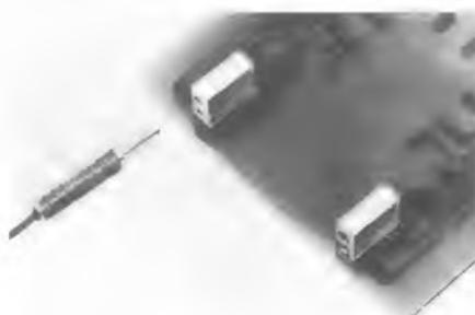
Bild 7. Prüfbuchse für gedruckte Schaltungen von der Firma Tuchel-Kontakt
