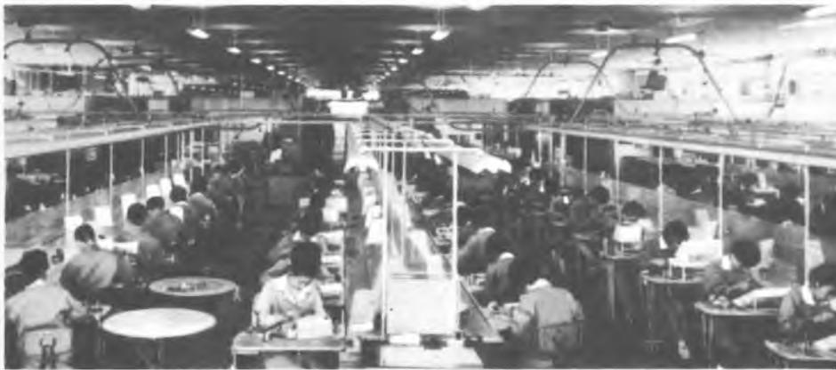
Alle Einzelteile von NATIONAL-Geräten werden in eigenen Werken hergestellt. Unser Bild zeigt einen Ausschnitt der modernen Fertigungsstraßen für den Zusammenbau von Transistor-Radios.
