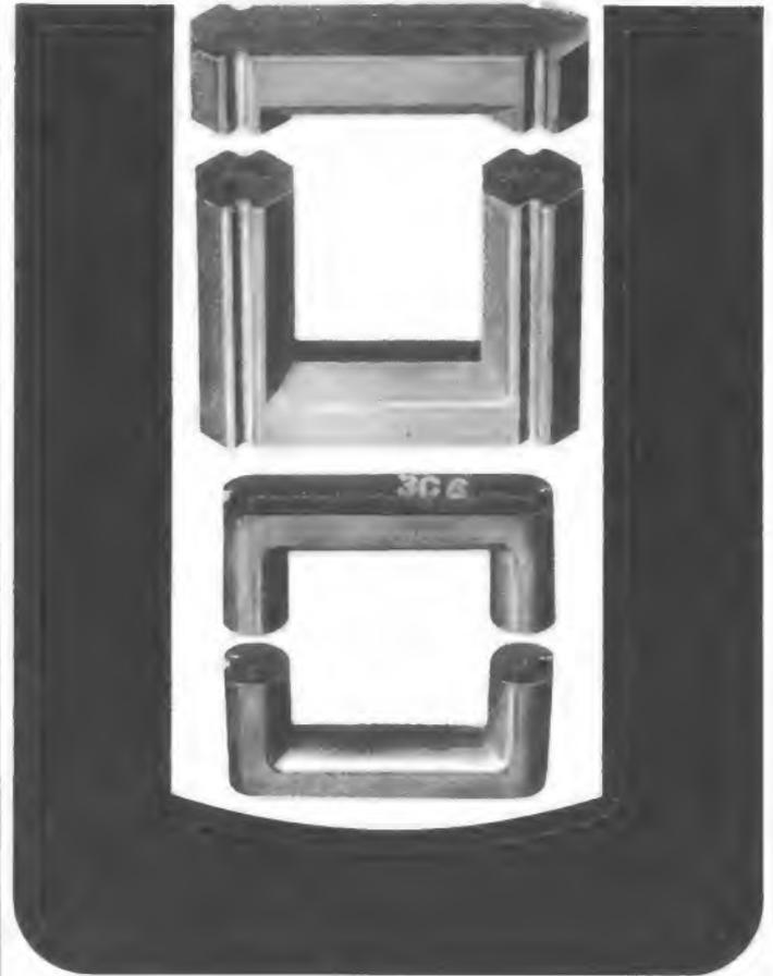
Wesentliche Merkmale der VALVO U-Kerne für Zeilentransformatoren in Fernsehgeräten sind hohe Sättigung, niedrige Kernverluste und günstiges Temperaturverhalten. Diese Eigenschaften konnten durch den neuen Ferroxcube-Werkstoff 3C6, der unseren bisherigen Werkstoff 3C5 ablöst, noch verbessert werden. Insbesondere weist Ferroxcube 3C6 auch bei niedrigen Temperaturen, wie sie in transistorisierten Fernsehgeräten auftreten, geringe Kernverluste auf.
