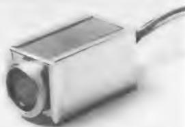
temperaturstabilisierter Thermostat eine Schaltzeitverzögerung von etwa zwei Minuten. Der Dämmerungsschalter ist weitgehend temperaturunabhängig und kann direkt ins Armaturenbrett eingebaut werden (Bild). Er ist für Batteriespannungen von 6 V, 12 V oder 24 V lieferbar. Die Schaltleistung beträgt 36 W bei 6 V (Ing. D. Loese, Mainz-Kastel, Große Kirchenstr. 19).
