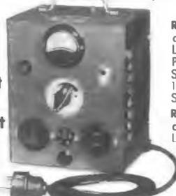
In tragbarem Stahlgehäuse, mit Voltmeter, Glühlampe u. Sicherung
