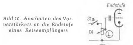
Bild 10. Anschalten des Vorverstärkers an die Endstufe eines Reiseempfängers
