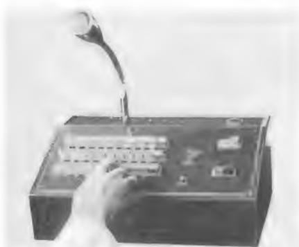
Bild 2. Das Bedienungspult enthält die Tastatur für den Selektioruf der einzelnen Teilnehmer
