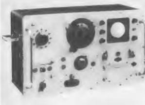
verstärkung ermöglicht eine genaue Beurteilung der zu beobachtenden Frequenzkurve. Die Empfindlichkeit des Vertikalverstärkers beträgt 4 V/cm. Der Frequenzbereich erstreckt sich von 5 MHz bis 230 MHz und von 470 MHz bis 880 MHz. Der Wobbelhub ist von 0,5 MHz bis 20 MHz einzustellen. Die Ausgangsspannung beträgt maximal 50 mV an 75 Ω, sie ist um 60 dB stetig abzuschwächen. Hersteller: Matrix, Compagnie Générale De Métrologie, Ancey/Haute-Savoie (Frankreich).
