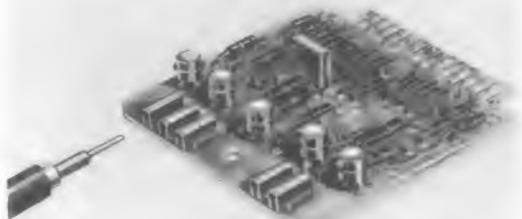
Bild 3. Gedruckte Schaltung mit Amp-Prüfbuchsen am Rand und in der Mitte (hochstehend). Die Buchsen sind für 2-mm-Prüfstecker vorgesehen, die man von beiden Seiten her einstecken kann
