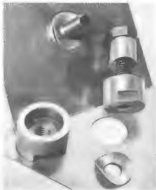
Hochwertiges Spezialwerkzeug zum Ausstanzen von Löchern für alle Materialien bis 1,5 mm Stärke geeignet. Sämtliche Größen v. 10...65 mm (je mm steigend) lieferbar. DM 9.10 bis DM 49,-
