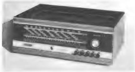
Bild 1. Speziell für Hf-Stereophonie entwickelter Rundfunk-Tuner RT 50
