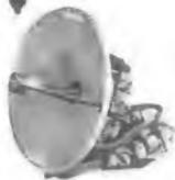
Radar-Parabol-Spiegel Ø 480 mm (metallisierter Kunststoff) mit Hohlleiter. Allseitig drehbar mit eingebauten Motoren und Drehfeldsystemen.
