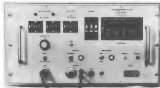
Das Geschwindigkeitsmeßgerät stellt außer der Gesamtzahl der vorbeifahrenden Fahrzeuge auch die Anzahl derjenigen fest, die eine vorgewählte Geschwindigkeit überschritten haben (P-E-K-Electronic)
