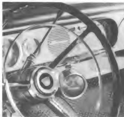
Bild 3. Der Drehzahlmesser in einem PKW ein-gebaut; die Skala wurde etwas unterhalb des Armaturenbrettes (im Bild rechts neben der Steuersäule) angeordnet
