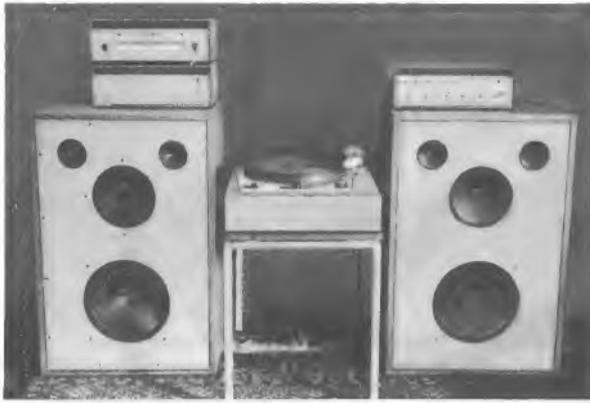
Bild 2. Gesamtansicht der Stereoanlage, die Lautsprecherbespannung ist abgenommen. Auf der linken Lautsprecherbox stehen der UKW-Tuner und der Endverstärker, auf der rechten das Steuergerät
