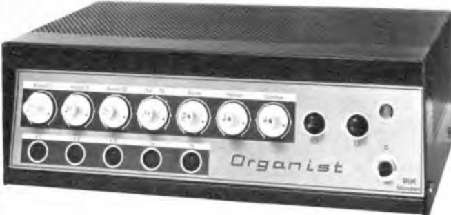
Ein hochwertiger, vielseitig einsetzbarer und sehr bewährter 10-Röhren-Vollverstärker mit 5 Eingängen, davon 4 miteinander mischbar. Getrennte Höhen- und Baßregelung. Summenregler. Ultralinear-Gegentaktendstufe mit 4 Lautsprecher-Endröhren.
