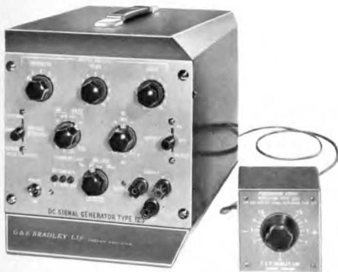
Die Bradley-Gleichspannungs-Eichquelle Type 123 bietet viele Anwendungsmöglichkeiten in der Entwicklung, Fertigung, Prüfung und Eichung von elektrischen und elektronischen Bauteilen und Instrumenten.
