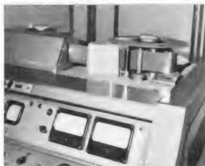
Bild 7. Teilansicht eines russischen Videoaufzeichnungsgerätes (Bandgeschwindigkeit 36,1 cm/sec, Bandbreite 50 Hz...6,5 MHz)
