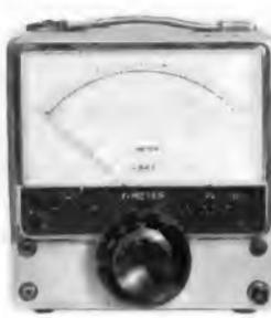
Direktanzeigender Frequenzmesser für Bereiche von 10 Hz bis 100 kHz
