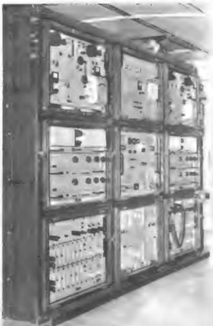
Bild 3. Richtfunk-Verbindungsgerät FM 120/5000 für mobile Anwendung (Telefunken)
