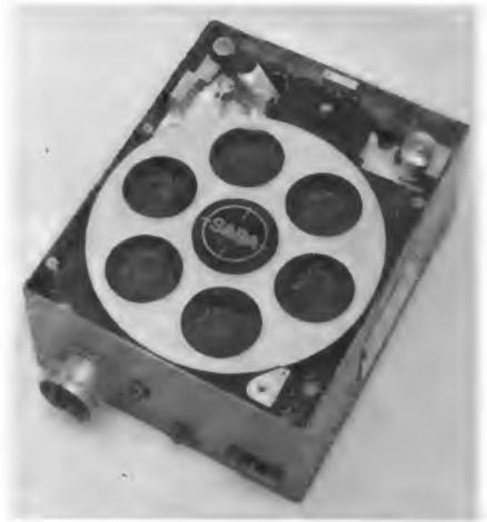
Bild 11. Robustes Magnetband-Aufzeichnungsgerät für Weltraumsatelliten (Saba/PI)
