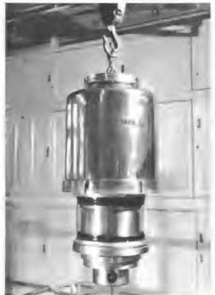
Bild 6. 500-kW-Senderöhre RS 1828 mit Siedekühlung
