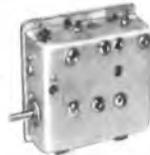
**UHF-Converter-Tuner** mit Transistoren 2  $\times$  AF 139 zum Einbau in jeden Fernsehempfänger. Die Abstimmung erfolgt kapazitiv und nahezu frequenzlinear. Unteretzter Antrieb 1 : 6,5; Ant-Eingang 240  $\Omega$ ; Ausgang 240  $\Omega$  jetzt nur 43,-
