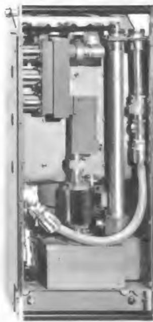
Bild 4. Parametrischer Empfangsverstärker für die Richtfunkstrecke FM 960-TV/1900 mit einer Pumpfrequenz von 6,5 GHz (Telefunken)
