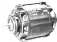
Einphasenmotor (Spalt-pol), kommerzielle Ausführung. Hochwertiger Spezialmotor für besondere Ansprüche. Völlig geräuschloser Lauf. Zwei eingebaute rotierende Kühlflügel. Spannung: 220 V~, Ampere: 0,6. Hz: 50. U min: 1420. Watt: 60. PS: 1/25. Axialspiel: 0,51 mm max., DIN 40 621.
