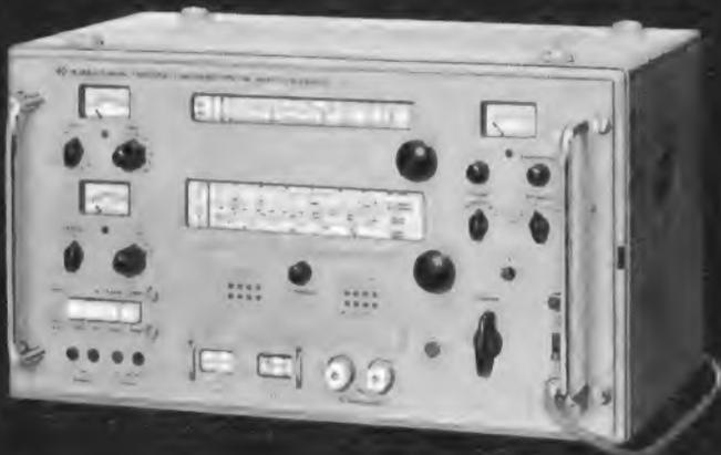
Dieses Gerät mißt die komplexen Parameter in Emitterschaltung bei den Festfrequenzen 0,02/0,1/0,5/1,65/5,5/10,7/21,4/36,6 MHz. Transistor-Arbeitspunkte:  $U_{CB} = 0,3 \dots 100 \text{ V}$ ,  $I_C = 10 \mu\text{A} \dots 100 \text{ mA}$ . Kleinste Meßbereiche für  $I_{CBO}$  und  $I_{EBO}$  sind  $30 \mu\text{A}$ . Mit Hilfsgaräten ist die Phase der Steilheit zu ermitteln. Kapazitätsdioden können ausgemessen werden.
