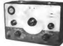
KAPAZITÄT- u. WIDERSTANDS-MESSBRÜCKE RCR 48. Meßbereiche: Kapazität 20 pF bis 2000  $\mu$ F in 4 Bereichen, Widerstände 2  $\Omega$  bis 200 M $\Omega$  in 4 Bereichen. Dem Gerät sind außerdem als Meßspannung zu entnehmen 3, 6, 12, 25, 50, 160, 250, 300, 350, 400, 450, 600 V =. Röhren: 6 X 4, 6 E 5, eingebautes  $\mu$ A-Meter. Das Gerät kann universell in der Radio- und Fernseh-technik eingesetzt werden 229.-
