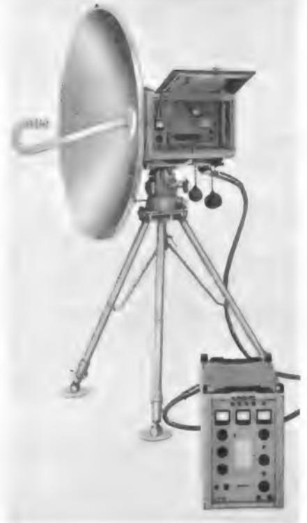
Bild 1. Tragbare Fernseh-Reportage-Richtfunkanlage FM TV/7000 R von Felten & Guillaume. Vorn der abgesetzte aufzustellende Senderbediengerät
