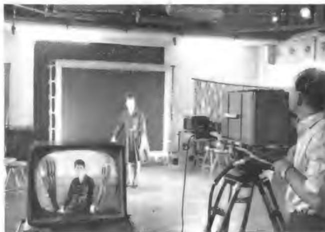
Untersuchung einer Reflexionswand für die Aufprojektion von Hintergrundbildern. Die Bildwand besitzt einen sehr hohen, allerdings nur in der Einfallrichtung wirkenden Reflexionsfaktor. Der Hintergrund wird von der Fernsehkamera aus mit Hilfe eines Kleinbild-Diaprojektors projiziert, links unten ist das kombinierte Bild zu sehen, wie es auf dem Fernsehschirm erscheint
