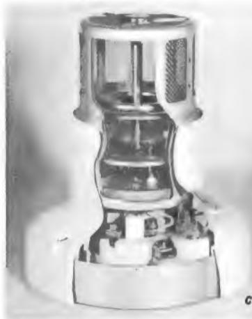
Bild 94. Meßwertaufnehmer nach dem Ionisationsprinzip; a = Wärme ionisiert die Luft in einem Kondensatorfeld; b = ein Radiumisotop RI ionisiert die Luft in einem Kondensatorfeld. Dringt in das Kondensatorfeld ein anderes Gas, z. B. Rauchgas, ein, dann ändert sich die Ionisation, man kann dies als Brandmeldeeinrichtung anwenden.
