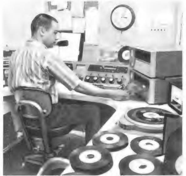
Rechts: Bild 6. Magnetscheiben sind die Tonträger im automatischen Tonaufzeichnungsverfahren von Ampex, Modell AG-100 cue-automatic; sie werden zum Anspielen einfach in den Schlitz der rechts erkennbaren Geräte gesteckt
