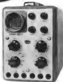
Kleinstoszillograph 30 Hz bis 250 kHz
