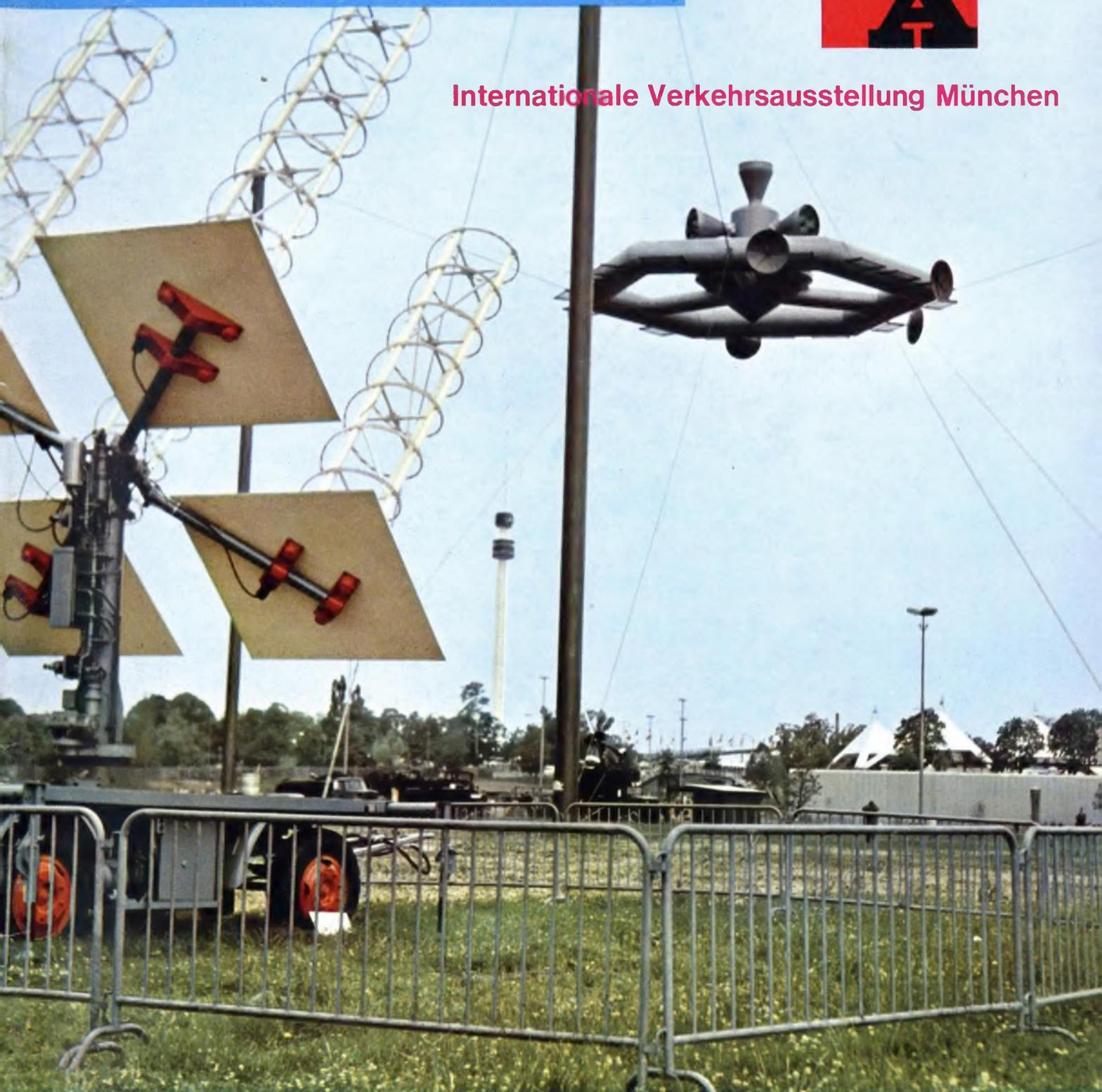
Vierfach-Wendelantenne einer Bodenempfangsstation für Fernmeßsignale von Raumfahrzeugen.
