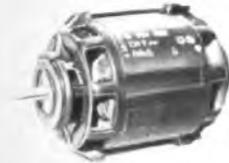
Einphasenmotor (Spalt-pol), kommerzielle Ausführung. Hochwertiger Spezialmotor für besondere Ansprüche. Völlig geräuschloser Lauf. Zwei eingebaute rotierende Kühlflügel. Spannung: 220 V~, Ampere: 0,8. Hz: 50, U/min: 1420. Watt: 60, PS: 1/25, Axialspiel: 0,51 mm max., DIN 40 621.
