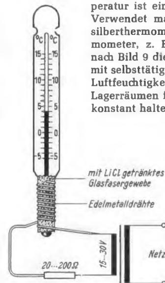
Bild 93. Prinzip des Lithiumchlorid-Feuchtemessers. Auf das getränkte Glasfasergewebe sind zwei nicht miteinander verbundene Edelmetalldrähte aufgewickelt. Die  $LiCl$ -Lösung schließt den Stromkreis
