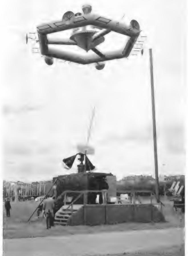
Als Wahrzeichen der IVA ist das Modell einer Weltraumstation gedacht, das hier über einer fahrbaren Wendelantenne schwebt, die zum Aufnehmen der Funksignale von Wettersatelliten dient
