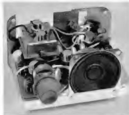
Bild 2. Trotz seiner Kleinheit ist das Gerät mit acht Transistoren bestückt
