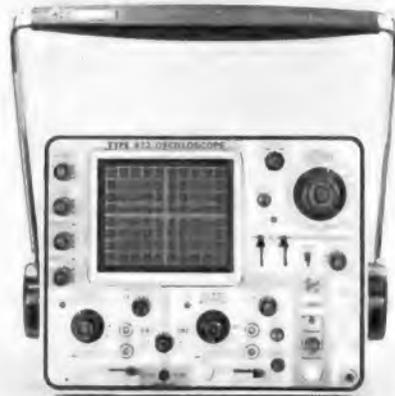
Der tragbare Service-Oszillograf Typ 422 von Tektronix
