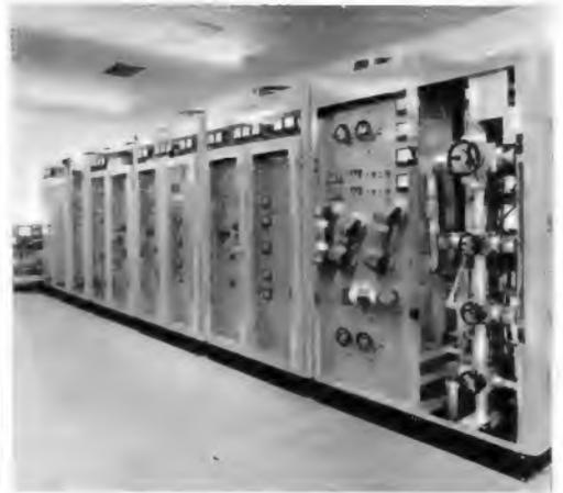
Bildsenderteil eines UHF-Fernsehenders von Rohde & Schwarz; der Tonsenderteil umfaßt eine ähnlich umfangreiche Schrankwand
