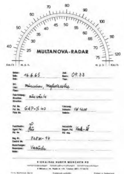
Bild 8. Meßprotokoll des Multanova-Radars. Die gemessene Geschwindigkeit wird im Original durch einen roten Kreisbogen ausgedruckt. Sie ist hier durch ein Graueraster gekennzeichnet
