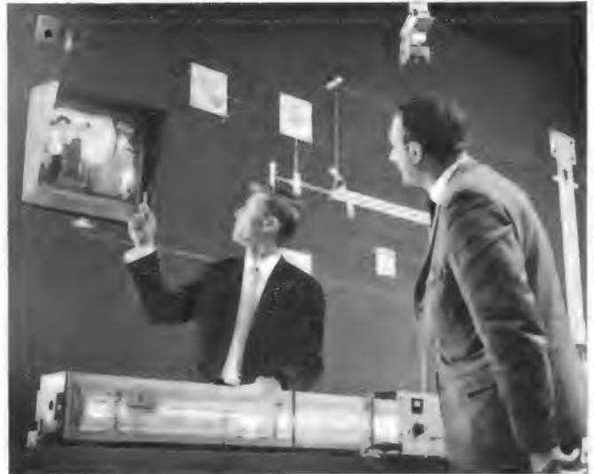
Bild 1. Das Demonstrationsmodell eines Helium-Neon-Gas-Lasers. Oben links über dem Fernseh-Sichtgerät ist die Aufnahmekamera eingebaut. Oben rechts ist der Umlenkspiegel zu erkennen, der den Laserstrahl zum Empfangssystem leitet
