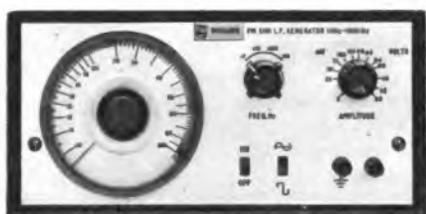
**netzunabhängiger RC-Generator PM 5101 für Sinus- und Rechteckspannung**, Frequenzbereich  $10 \text{ Hz} \dots 100 \text{ kHz}$
