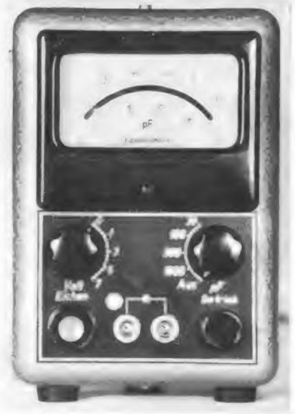
Bild 1. Vorderansicht des Kapazitätsmeßgerätes
