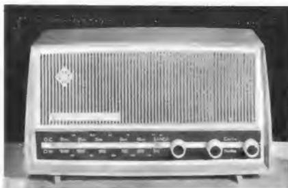
Bild 1. Einfacher, von Telefunken in Madrid gefertigter und vielfach exportierter Allstrom-Tischempfänger Modell Panchito, bestückt mit UCH 81, UF 89, UABC 80 und UL 84, dazu Netzgleichrichter E 125 C 80
