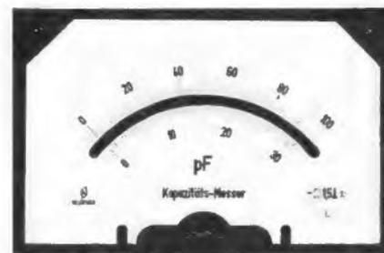
Bild 13. In Kapazitäten geeichte Skala des Meßwerkes
