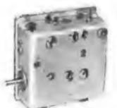
**UHF-Converter-Tuner** mit 2 Transistoren AF 139, zum Einbau in FS-Geräte der deutschen, französischen und US-Norm. Er dient zum Empfang von UHF-Sendern im Bereich von 470-880 MHz. Die Abstimmung erfolgt kapazitiv und nahezu frequenzlinear. Unter-setzer Antrieb 1 : 6,5. Antenneneingang: 240 Ω. Antennenausgang: 60 Ω (Kanal 3 oder 4, 54-88 MHz) 42.-
