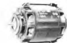
Einphasenmotor (Spaltpol), kommerzielle Ausführung. Hochwertiger Spezialmotor für besondere Ansprüche. Völlig geräuschloser Lauf. Zwei eingebaute rotierende Kühlflügel. Spannung: 220 V~, Ampere: 0,6, Hz: 50, U/min: 1420, Watt: 60, PS: 1/25, Axialspiel: 0,51 mm max., DIN 40 621.
