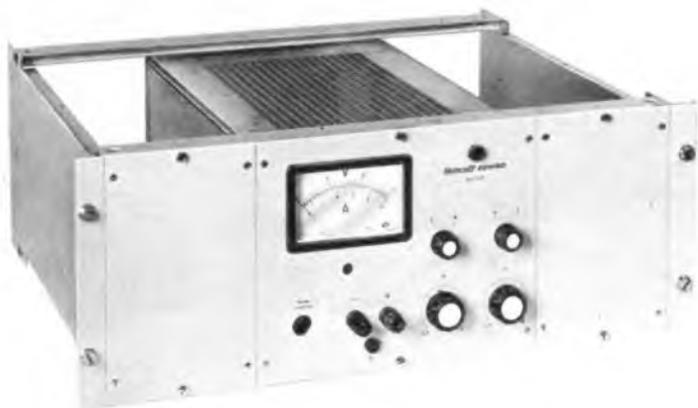
Transistorstabilisierte Netzgeräte in Istep-Bauweise (Internationales-Standard-Teileinschub-Programm) zum wahlweisen Einbau im Tischgehäuse oder Rahmeneinsatz für 19"-Gestelle.
