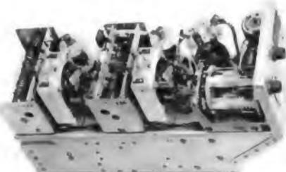
**12 Watt VHF-AM-Flugzeug-TX; Frequenzbereich 100-146 Mc.**
