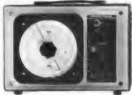
**NF-Prüfgenerator RWG 2**, unentbehrlich für jede Werkstatt zur Prüfung von NF-Verstärkeranlagen u. zur Erzeugung eines Bildmusters bei FS-Geräten. Frequ.-Ber.: bis 500 kHz in 4 Bereichen. Wellenform: Rechteck, Anstiegszeit < 100 nsec, Dachabfall bei 50 Hz < 2 %, Ausg.-Spannung an 10 kΩ, 0,1-3 Vas. Fremdsynchronisation möglich, dadurch im Zusammenhang mit Oszillografen sehr gut zu gebrauchen. Rö.: EC 91, EF 80, ECC 81, EZ 80 nur 129.—
