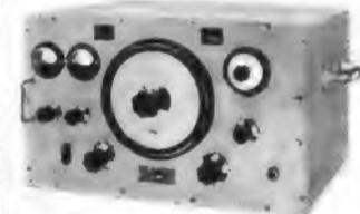
**Präzisions-Meßsender EMS 262**, Frequenz-Ber.: 2,5-3,8 MHz u. 8-154 MHz in 8 Bereichen. Frequenzgenauigkeit besser als 0,5 %, genau
