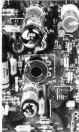
Der Service-Druck auf dem Chassis gibt die Lage und die Werte der Bauelemente an. Eine Vereinfachung, die Sie als Techniker zu schätzen wissen.
