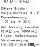
Offene Brücke Vergleichsmessung R u. C Prozentmessung -20 bis +20% Inl.-Messung zwischen 10 M $\Omega$  und 10000 M $\Omega$  Eingab. Meßstrecke Stromversorgung 110/220 V / 50 Hz 400,-
