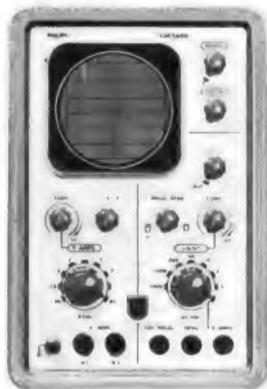
**handlicher Service-Oszillograf GM 5600 X, 0 ... 5 MHz**
