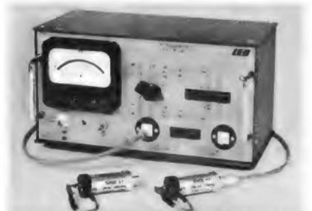
Mikrovoltmeter mit quadratischer Anzeige der Firma Lea
