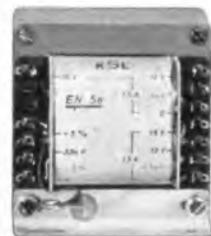
Netztransformator in elektronischen Schaltungen. Manteltransformator mit galvanisch getrennten Wicklungen sowie Schutzwicklung zwischen Primär- u. Sekundärwicklungen. Die beiden Sekundärwicklungen 15 V mit den Anzapfungen 12 u. 10 V können hintereinander oder parallel geschaltet werden.
