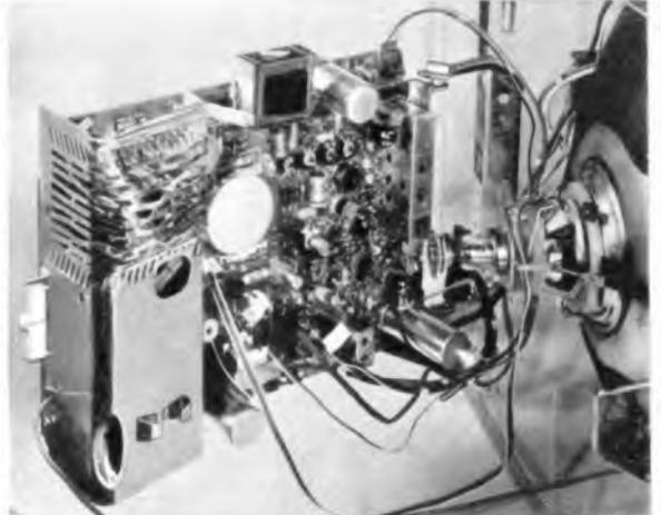
Das 100% gedruckte Chassis 1823 ist durch Steckerleisten mit anderen Baugruppen verbunden. Nach Lösen einer Schraube können Sie das Chassis herauschwenken. Ein Griff zum Knebelknopf, und das Chassis ist ausgebaut.
