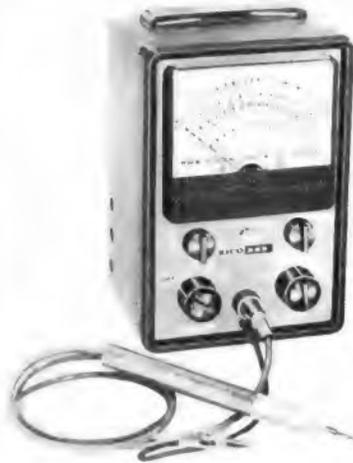
Röhrenvoltmeter Modell 222 mit umschaltbarem Tastkopf
