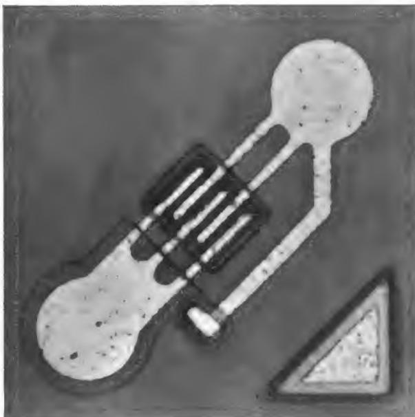
Das System des Silizium-Planar-Transistors BF 167
