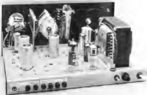
Bild 5. Innenaufbau des Röhrenvoltmeters
