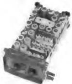
WS 88 quartzesteuertes 4-KANAL-SENDEEMPFÄNGER
