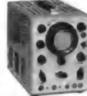
4 MHz Service-Oszilloskop EO 1/71 Vertikal-(Y-)Steuerung, Frequ.-Ber. 1.5-4 MHz (-3 dB). Horizontalsteuerung durch Zeitblenkgenerator per (über X-Verstärker) Frequenzbereich: 5 Hz...400 kHz, durch X-Verstärker Frequ.-Ber.: 3 Hz...1 MHz, Schirm $\phi$  70 mm
