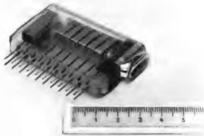
Der zwölfstufige Fotovervielfacher XP 1170 in Quaderbauform und mit Saphirfenster ist für die Fotometrie und UV-Meßtechnik bestimmt
