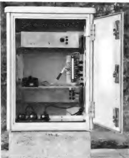
Bild 7. Der Sender im wetterfesten Gehäuse am Rand der Autobahn
