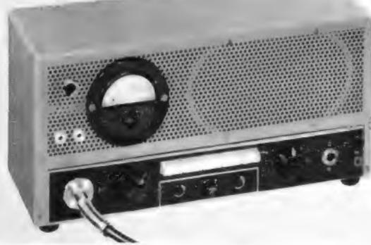
Bild 1. Das kombinierte Prüfgerät *Universer* enthält sechs Festfrequenz-Hf-Oszillatoren, einen 400-Hz-Tongenerator, einen Prüflautsprecher und einen Ausgangsspannungsindikator
