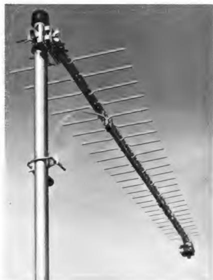
Bild 6. Bei der Antenne Typ Durant 26 erkennt man deutlich den Kurzschluß der Trägerrohre am Mast sowie das Anpassungskästchen am vorderen Ende der Antenne
