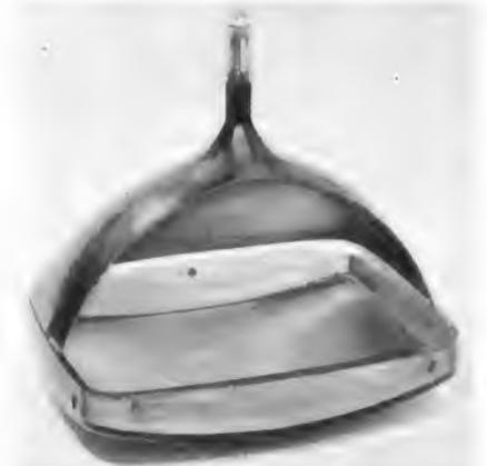
Bild 2. Aufgeschnittener Kolben der Farbbildröhre. Die Lochmaske ist herausgenommen, so daß zwei der drei Chromeisenstifte sichtbar sind. An der Außenseite des Schirmglases befinden sich drei geschliffene Anlageflächen
