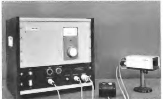
Bild 1. Das dargestellte Impuls-Lasergerät von Philips besteht aus dem Laserkopf (rechts), dem Fernbedienungsteil (Mitte) und dem Speisegerät mit einstellbarer Spannung (links). Im Laserkopf sind ein Rubinstab und eine Xenon-Blitzröhre eingebaut. Das Speisegerät ist für eine Arbeit von maximal 500 Wsec ausgelegt. Mit dem schwarzen Kästchen läßt sich die Aufladung und die Zündung fernbedienen
