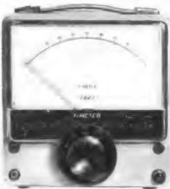
Direktanzeigender Frequenzmesser für Bereiche von 10 Hz bis 100 kHz
