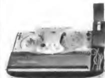
Techn. Daten: Batteriebetrieb (4 Monozellen à 1,5 V), Maße 320 x 195 x 80 mm, Gew. o. Batt. 3 kg, Spulen-Ø 8 cm, Halbspur, Bandgeschwind. im Mittel 5,6 cm/sec, Spieldauer mit Doppelspielband ca. 2 x 30 Min., Frequenzumfang ca. 250-5000 Hz, Aufnahmeempfindlichkeit ca. 0,5 mV, Ausgangsleistung ca. 50 mW, 6 Transistoren, direkte Anschlußmöglichkeiten.
