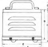
Stahlblechgehäuse, roh oder lackiert, Oberteil und Boden verschraubt. Im Boden sind Bohrungen für Klemmen und Aufhängung
