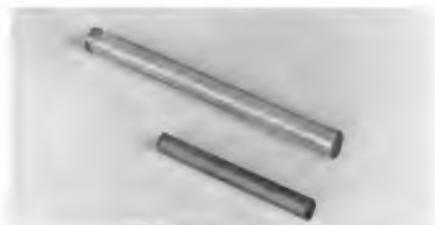
Bild 12. Das Bild zeigt zwei zylindrische Laserstäbe von Carl Zeiss, Oberkochen. Der größere Stab besteht aus Neodym, der kleinere aus Rubin
