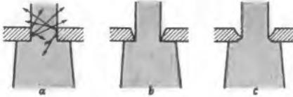
**Bild 4. Schnitt durch die Maske in der Ebene eines Loches in Bildschirmitte.** Bei schräg auftreffendem Elektronenstrahl an den Bildrändern sind die Verhältnisse bei einem zylindrischen Loch noch ungünstiger; a = Entstehung von Streuelektroden bei zylindrischem Loch, b = ideale, konische Lochform, c = durch Ätzung erreichte, angenähert konische Lochform
