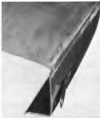
**Bild 5. Schnitt einer Lochmaske; er zeigt eine der am Metallrahmen angeschweißten drei Haltefedern**
