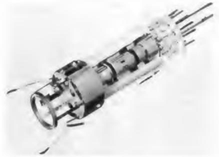
Bild 1. Dreifach-Elektronenstrahlssystem der Farbbildröhre A 63-11 X
