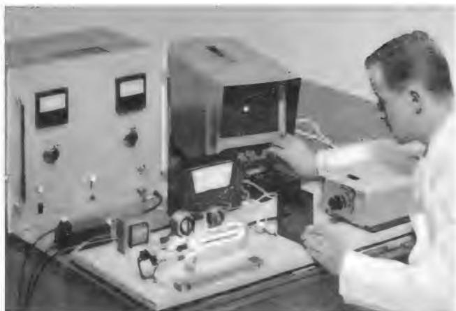
Bild 9a. Versuchsaufbau mit parallel angeordneter Pumplichtquelle
