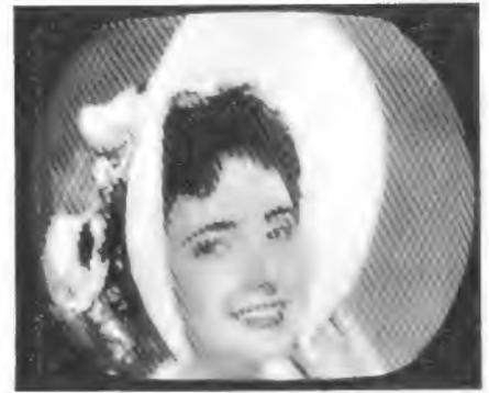
Bild 6. Durch einen periodischen Störer verursachtes Leuchtdichtemöire als Schwarzwelßbild empfangen. Die Störschwingung liegt etwa 1,0 MHz oberhalb des Bildträgers
