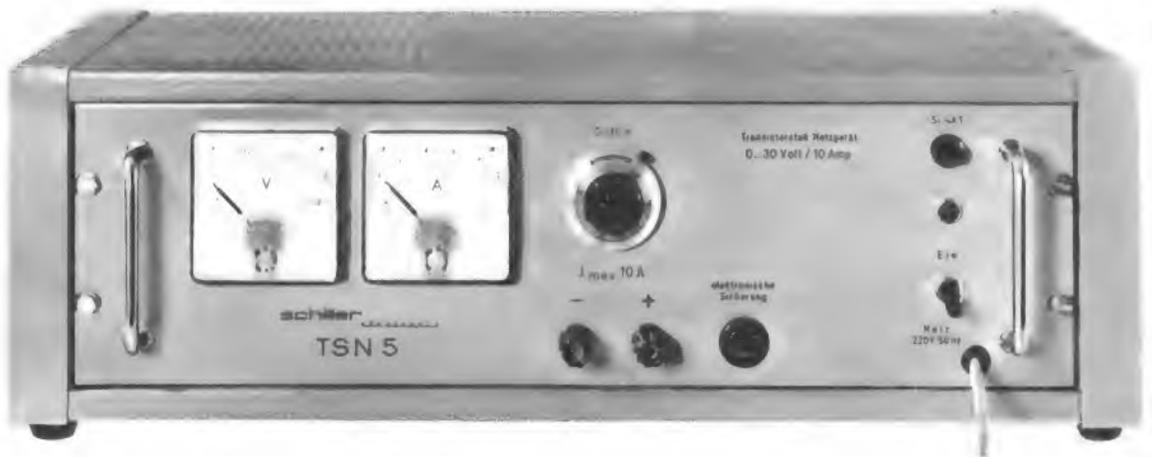
Abb. **TSN 5**, Ausgangsspannung 0...30 V, kontinuierlich einstellbar bei einem Strom von 10 A,  $R_i \leq 0,5 \text{ m}\Omega$ , Restwelligkeit  $\leq 0,5 \text{ mV}$  Konstanz der Ausgangsspannung, bei Netzspannungsänderung von  $\pm 10 \%$ ,  $\pm 0,01 \%$ , Regelzeit von 0 auf Nennstrom  $< 50 \mu\text{Sek.}$
