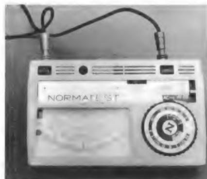
Leichter und handlicher Vielfachmesser Normatest; die Spezialmeßleitungen sitzen so fest, daß man das Gerät an den Schnüren hängend benutzen kann; für die Prüfgriffe gibt es noch aufsteckbare Verlängerungsspitzen
