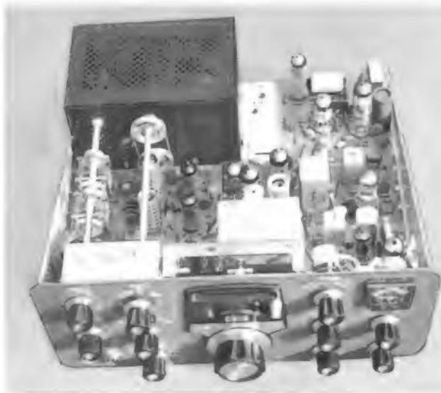
Bild 10. Chassisansicht des SB 100. Links hinten in der Abschirmung ist die Sender-Endstufe untergebracht
