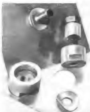
Hochwertiges Spezialwerkzeug zum Ausstanzen von Löchern für alle Materialien bis 1,5 mm Stärke geeignet. Sämtliche Größen v. 10 — 65 mm (je mm steigend) lieferbar.
