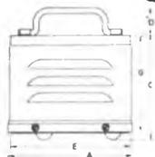
Stahlblechgehäuse, roh oder lackiert, Ober- und Boden verschraubt. Im Boden sind Bohrungen für Klemmen und Aufhängung
