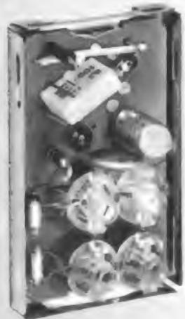
Links: Bild 1. Geöffnetes Modul (AM/FM-Zf-Verstärker). Die Anschlußstifte liegen auf der Rückseite
