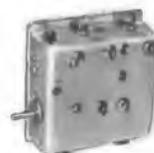
UHF-Converter-Tuner mit 2 Transistoren AF 139, zum Einbau in FS-Geräte der deutschen, französischen und US-Norm. Er dient zum Empfang von UHF-Sendern im Bereich von 470-860 MHz. Die Abstimmung erfolgt kapazitiv und nahezu frequenzlinear. Unter-setzer Antrieb 1:6.5. Antenneneingang: 240 Ω. Antennen- ausgang: 240 Ω (Kanal 3 oder 4, 54-68 MHz)
