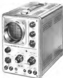
Mit Y-Verstärker 2 Hz — 5 MHz (-6 dB)
