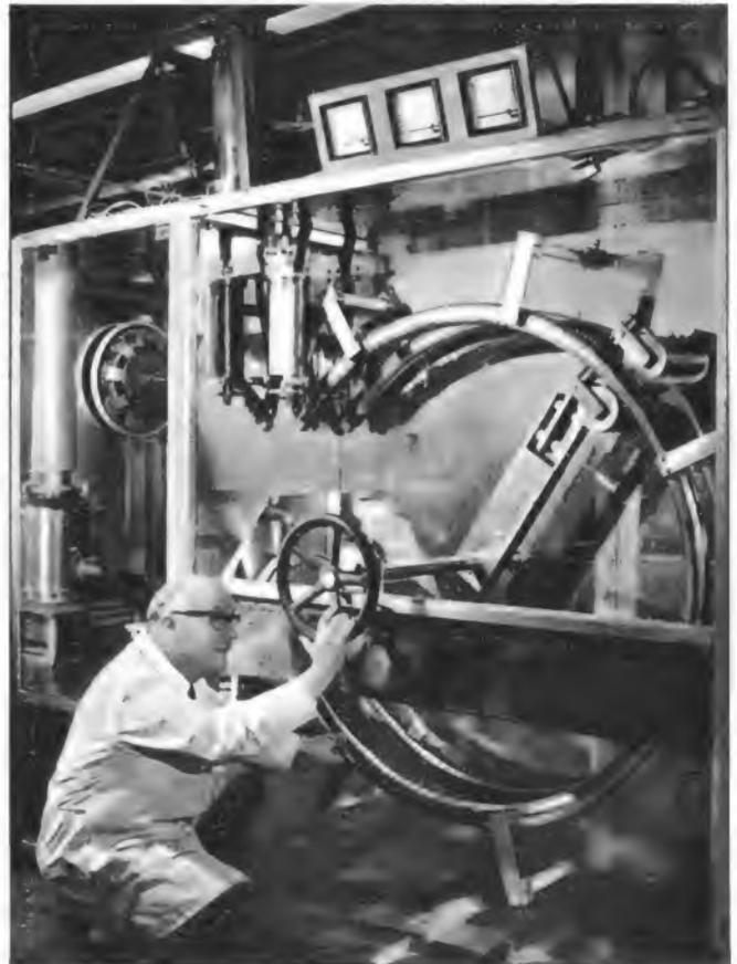
Bild 2. Variometer im Anodenkreis der Leistungs-Endstufe Hf 6
