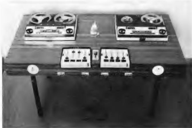
Außer den sichtbaren Bandgeräten und beiden Mischpulten befinden sich in der hohlen Tischplatte des Regietisches ferner noch zwei Vorverstärker und ein Hallgerät
