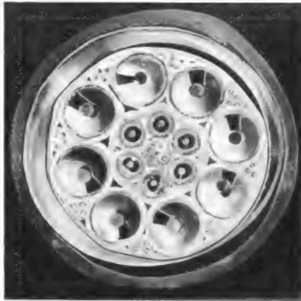
Bild 1. Querschnitt durch das Koaxialfern-kabel 32 b 1 W mit acht Normal- und sechs Zwerg-Koaxialpaaren. Bei voller Beschaltung können mit diesem Kabel unter Benutzung des Trägerfrequenzsystems V 2700 bis zu 11 700 Gespräche gleichzeitig übermittelt werden
