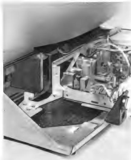
Bild 2. Das Chassislager, mit dessen Hilfe das Chassis in die beiden Servicestellungen gebracht werden kann
