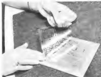
Bild 2. Die entwickelte Platte. Zum Vergleich wird die Vorlage daneben gehalten. Als Vorlage kann statt der glasklaren Folie auch Transparentpapier dienen (Hersteller der Platten: Bungard-Elektronik, Leverkusen)
