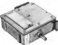
UHF-Konverter- oder Normaltuner (wahlweise) zum exakten seitlichen Einbau, m. Skalennopf, als Baustatz ausgerüstet, 2 Transistoren: 1 x AF 139, 1 x AF 239 (Vorstufe), Ausgang: Kanal 2—4, 240 Ω
