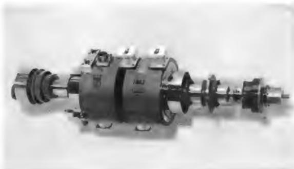
Links: Bild 1. Die Wanderfeldröhre N 1064 liefert eine Ausgangsleistung von 3...5 W im 10-GHz-Bereich (English Electric Valve Co. Ltd.)
