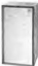
1. „Modell RB 4 N 20“ Eine hochwertige u. preisgünstige 4fach-Box für Mono- u. Stereo-Verstärkeranlagen in amerikan. Nußbaum oder Teak. Belastbarkeit: 20 Watt. Spitzenbelastbarkeit: 25 Watt. Frequenzbereich: 50—16 000 Hz. Anpassung: ca. 5  $\Omega$ . Bestückung: 1 Tieftön, 1 Mitteltön, 2 Hochtöner. Ganzseitig geschlossenes Gehäuse, mit Spezial-Dämpfungsmaterial ausgelegt. Aufstellung: stehend, liegend oder freistehend möglich.
