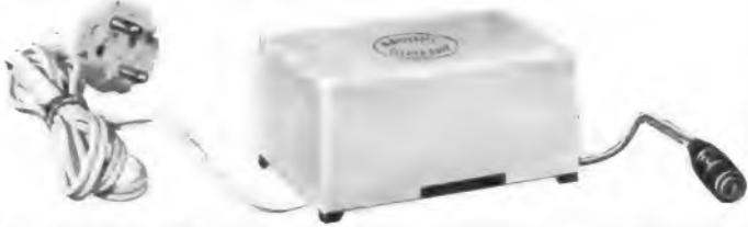
Das Netzspeisegerät für batteriebetriebene Kofferradio - Kleintonbandgeräte, Wechsel- und Funksprechanlagen mit einer Leistung bis zu 300 mA. Techn. Daten: 220 Volt Wechselstrom, sec.-seitig drei verschiedene Grundspannungen 6-7,5-9 Volt umschaltbar, Leistungstransistor, Zenerdioden, 2 Elkos, Kleinblockgleichrichter - auf gedruckter Schaltung. Die Einspeisung der anzuschließenden Geräte erfolgt über eine Adapterkupplung mit verschiedenen Adapteranschlußkabeln.
