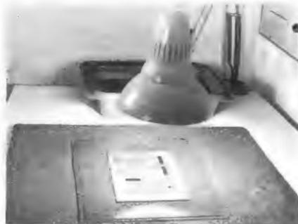
Bild 1. Zum Belichten werden Vorlage und foto-beschichtete Platte mit einer Glasplatte beschwert, um guten Kontakt zu gewährleisten, damit die Kanten der Zeichnung sauber herauskommen
