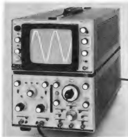
Bild 4. Für den Hewlett-Packard-Oszillografen 180 A sind drei Einschübe lieferbar. Er erlaubt Messungen bis 50 MHz
