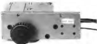
UHF-Schnelleinbaukonverter TC 2-E, stabilisierte Speisung, 2 Transistoren: 1 x AF 139, 1 x AF 239 (Vorstufe), Ausgang: Kanal 2—4, 240 Ω
