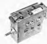
**UHF-Converter-Tuner\*** zum Einbau in FS-Geräte der deutschen, französischen und US-Norm. Er dient zum Empfang von UHF-Sendern im Bereich von 470-860 MHz. Die Abstimmung erfolgt kapazitiv und nahezu frequenzlinear. Unter-setzer Antrieb 1 : 6,5. Antenneneingang: 240 Ω. Antennenausgang: 240 Ω (Kanal 9 oder 4, 54-68 MHz) 35.—
