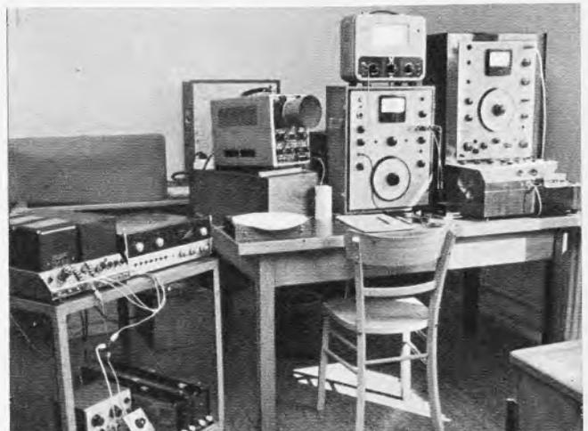
Bild 2. Lautsprecherboxen-Meßplatz mit Signalgenerator, Pegelschreiber (rechts) und daneben angeordnetem, umlaufendem Terzfilter. Links sind Vor- und Leistungsverstärker (75 W) zu sehen, darunter ein Regelverstärker für die Impedanzmessung und Ersatzwiderstände. Die Ausgangsspannung des Verstärkers wird mit Röhrenvoltmeter (auf dem Terzfilter stehend) und Oszillograf überwacht
