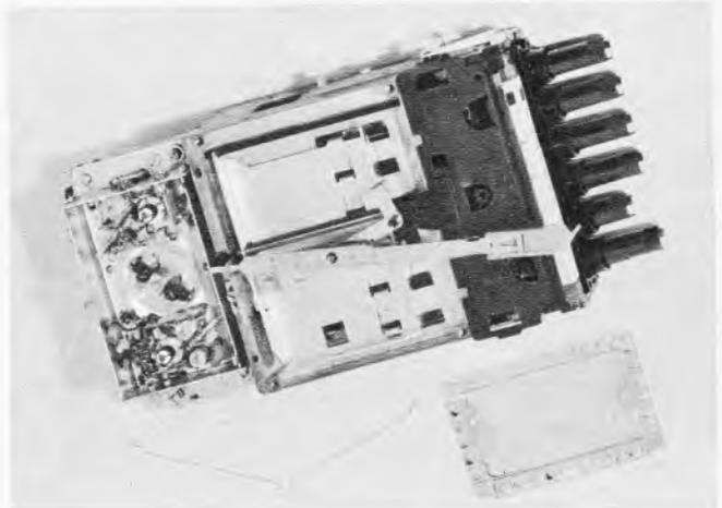
Bild 2. Gesamtansicht des integrierten Kanalwählers von Valvo
