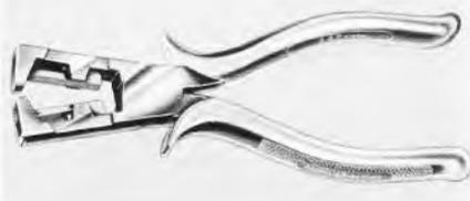
Bei dieser Abisolierzange braucht man die Drahtstärke nicht einzustellen. Sie eignet sich für Durchmesser von 0,5 mm bis 5,0 mm
