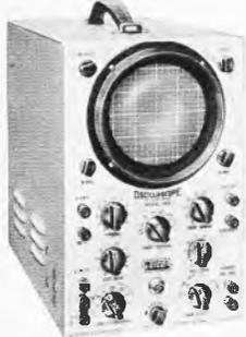
12,5-cm-Bildröhre mit Fluorlichtstossschleibe und kontinuierlicher Helligkeitsregelung, Strohlverschiebung horizontal und vertikal, Rücklaufverstärkung, Helligkeitsmodulationsanschluß, Eichspannung, 50 Hz und Sägezahnangabe.
