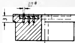
Bild 6. Die Festelektrode und der Kapselkörper mit den Bohrungen für das Luftpolster
