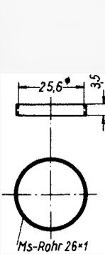
Bild 12. Ring zum Festkleben des Siebes
