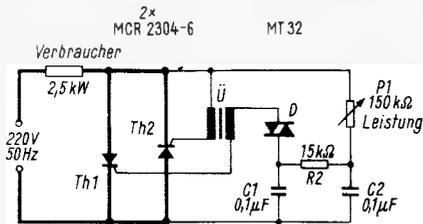
Bild 35. Zweiweg-Thyristorschaltung für größere Leistungen (Motorola)
