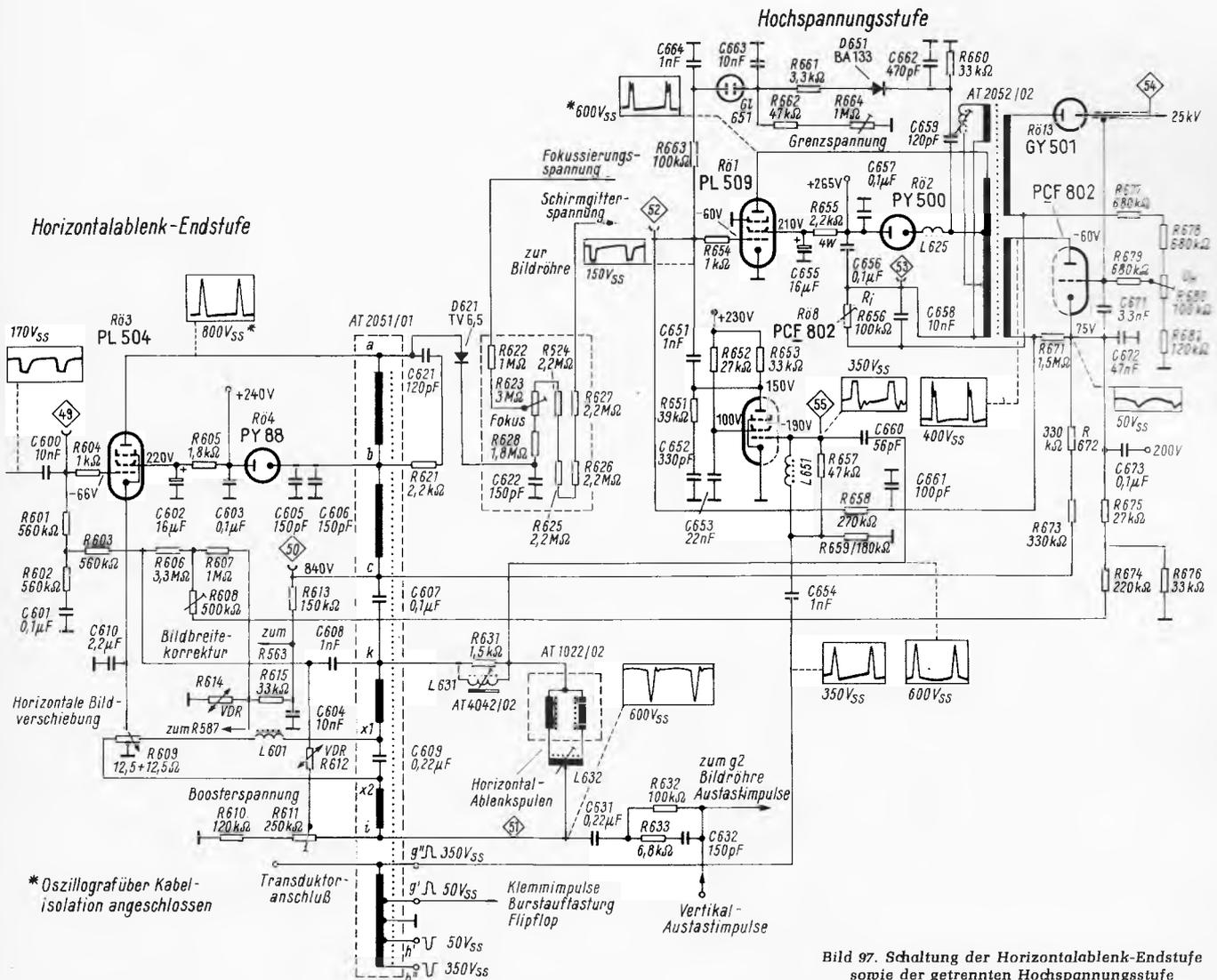
Bild 97. Schaltung der Horizontalablenk-Endstufe sowie der getrennten Hochspannungsstufe
