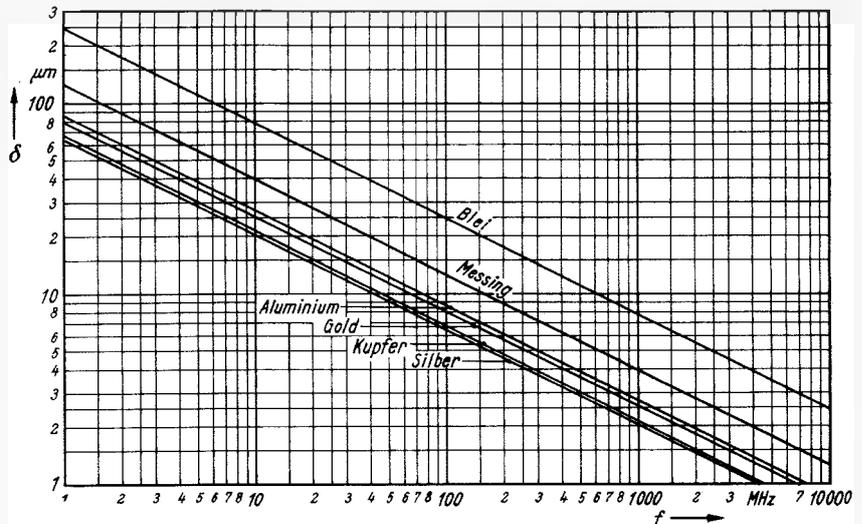
Leiterinneren zu nach einer Exponentialfunktion (Bild 3). Hierbei ist der Betrag der relativen Stromdichte – also der Betrag der Stromdichte an einer beliebigen Stelle im Leiterinneren, bezogen auf den Betrag der Stromdichte an der Leiteroberfläche – als Funktion der Entfernung von der Leiteroberfläche dargestellt worden. Die Größe  $\delta$  ist diejenige Entfernung von der Oberfläche, bei welcher der Betrag der Stromdichte den  $\frac{1}{e}$ -fachen (= 0,368fachen) Wert des Betrages der
