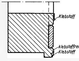
Bild 8. Die Kapsel mit Klebeflächen für die Membran
