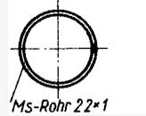
Bild 9. Die Abmessungen des Batterierohres
