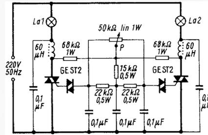
Bild 39. Tandem-Helligkeitssteuerung für zwei Glühlampenkreise (General Electric)
