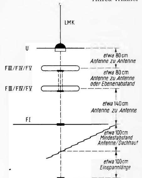
Bild 3. Beim Befestigen von mehreren Antennen an einem Standrohr sind bestimmte Mindestabstände einzuhalten
