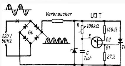
Bild 24. Phasenanschnittsteuerung eines Thyristors über einen Unijunction-Transistor. Die Netzwechselspannung wird durch eine vorgeschaltete Gleichrichterbrücke in eine Halbwellenspannung umgeformt
