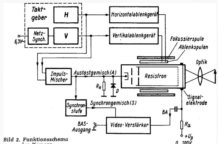
Bild 2. Funktionsschema der Kamera
