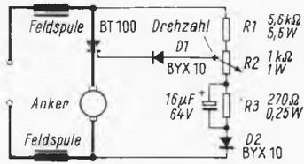
Bild 38. Drehzahlsteuerung und Drehzahlregelung für einen Universalmotor. Die Ankerwicklung liegt im Katodenkreis des Thyristors (Valvo)
