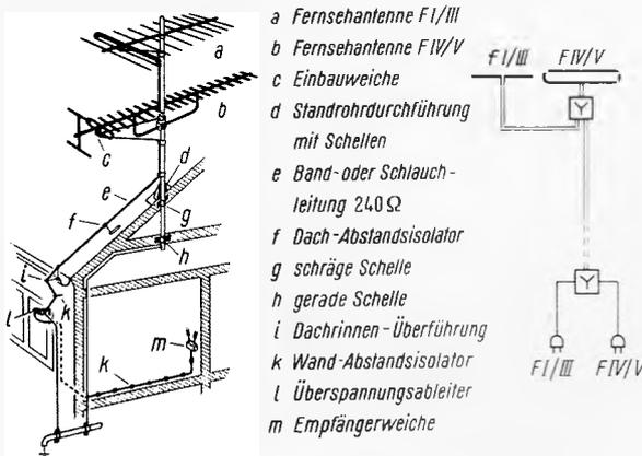
Bild 2. Bausteine einer Einzel-Antennenanlage für zwei Programme
