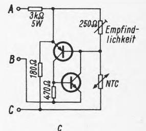
Bild 29. Verschiedene Beispiele für licht- und wärmegesteuerte Phasenanschnittgeräte aus dem RCA-Experimentierbuch (abgeändert für 220-V-Netz)
