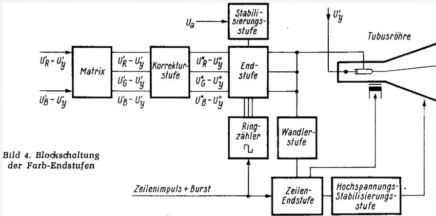
Bild 4. Blockschaltung der Farb-Endstufen
