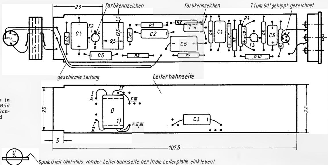
Bild 17. Die Printplatte in natürlicher Größe. Das Bild zeigt deutlich, wie die Bauteile angeordnet sind
