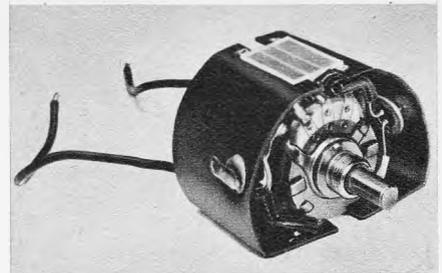
Bild 31b. Innenaufbau des Helligkeitseinstellers
