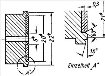
Bild 7. Schnitt durch die fertig gedrehte Kapsel
