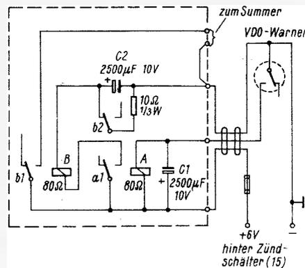
Bild 2. Schaltung eines kleinen Zusatzgerätes für den Geschwindigkeitswarner, die im Gegensatz zum Originalgerät einen kurzen Warnnton liefert. Änderungen am VDO-Warner sind nicht erforderlich
