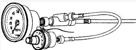
Bild 1. Zwischen Tachometer und Tachowelle wird der von VDO hergestellte Geschwindigkeitswarner angebracht
