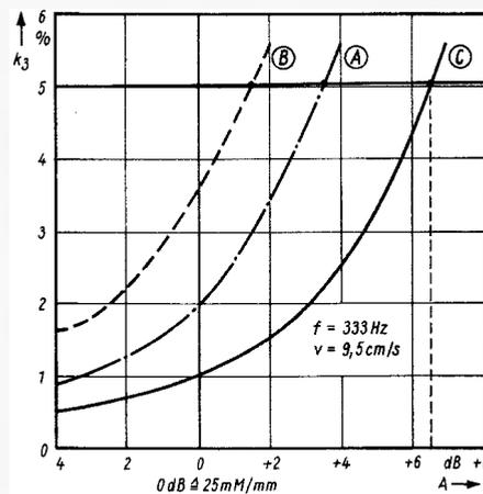
Bild 1. Klirrfaktor  $k_3$  in Abhängigkeit vom relativen Bandfluß A für drei verschiedene Bandgruppen bei konstanter Hf-Vormagnetisierung. A = herkömmliches Band, B = rauscharmes Band, C = rauscharmes Hochpegelband PES 35 LH
