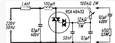
Bild 40. Phasenanschnittsteuerung mit einem DiTriac (RCA)
