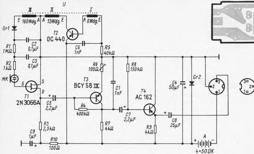
Bild 15. Gesamtschaltung des FET-Kondensator-Mikrofon
