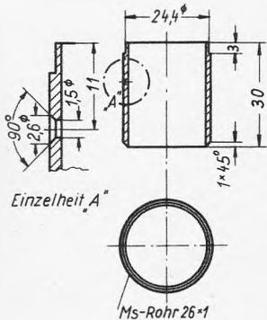
Bild 11. Maßzeichnung für das Kapselrohr
