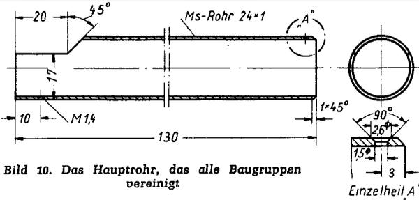
Bild 10. Das Hauptrohr, das alle Baugruppen vereinigt
