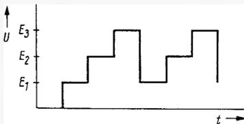
Bild 5. Signal für unbuntes Bild an der Tubuselektrode
