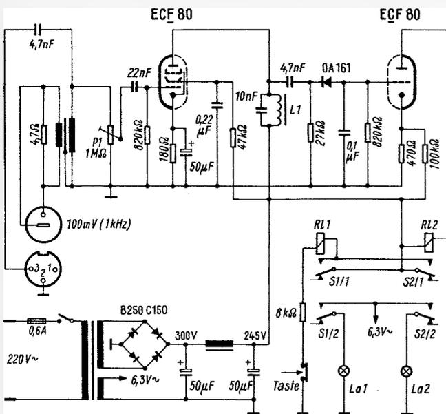
Schaltung eines einfachen Anzeigerätes von Aussetzfehlern in Rundfunk- und Tonbandgeräten. R1 = Siemens-Kammrelais 6500-418, 230-3300/0,09 CuL; R2 = Siemens-Kammrelais Bv 6500-421, 700-6900/0,07 CuL. Bei der Netzdrossel wurde der Luftspalt entfernt (Gleichstromwiderstand  $\approx 500 \Omega$ , Mindestbelastbarkeit = 80 mA, Induktivität  $\approx 3 \text{ H}$ )
