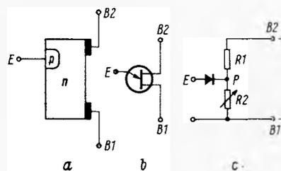
Bild 22. Aufbau, Schaltsymbol und Ersatzschaltung des Unijunction-Transistors
