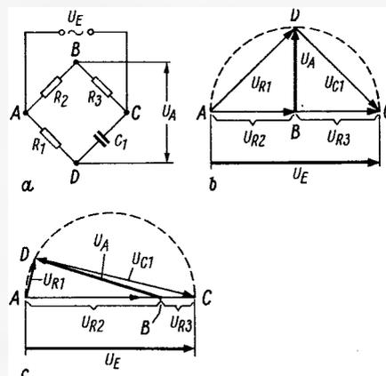
Bild 33. Wirkung der Phasenschieberbrücke: a = Prinzipschaltung, b = Phasenlage der Ausgangsspannung der Brücke bei gleich großen Impedanzen der Brückenarme, c = Widerstandswert  $R_2$  sehr groß, Widerstandswert  $R_1$  sehr klein, die Diagonalspannung ist um fast  $180^\circ$  gegenüber der Speisespannung gedreht
