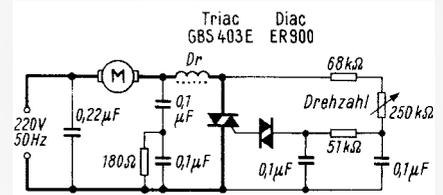
Bild 37. Drehzahlsteuerung für einen Universalmotor (Transitron)
