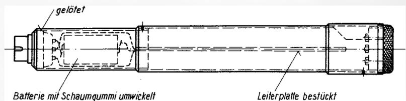
Bild 19. Der Zusammenbau sämtlicher Teile mit dem Hauptrohr
