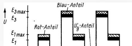
Bild 6. Diagramm des Purpur-Signales, wie es am Schirm vorhanden wäre
