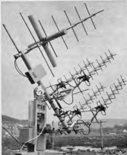
Spezialantenne für Satellitenbeobachtung, gebaut für das deutsche Forschungsschiff „Meteor“. Die einzelne größere Antenne empfängt 137,35 MHz, die Gruppe der vier kleineren die Frequenz 412,05 MHz
