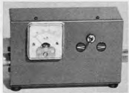
Bild 1. Außenansicht der selbstgebauten Stehwellen-Meßbrücke
