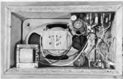
Bild 8. Einbau der Platinen in ein Lautsprechergehäuse
