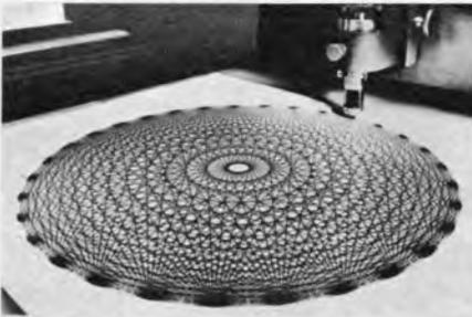
Oben: Rechner und Lochstreifen steuern eine Zeichenmaschine (Werkaufnahme: AEG-Telefunken)
