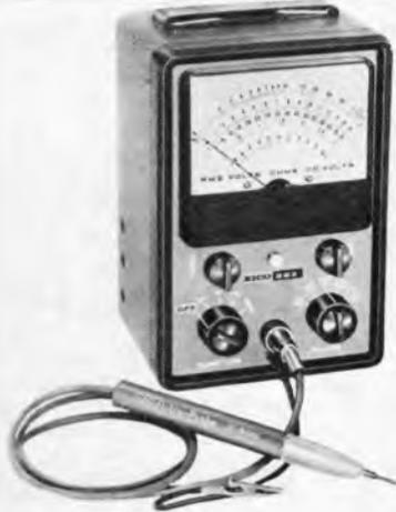
Röhrenvoltmeter Modell 222 mit umschaltbarem Tastkopf
