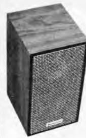
Mit 13-cm-Tiefton-Kolbenlautsprecher und 8-cm-Hochtonlautsprecher, optimal auf das Gehäuse abgestimmt, daher wird eine hohe Tonqualität und eine sorgfältige Resonanzdämpfung erreicht. Belastbarkeit: 15 W Frequenzgang: 40...20 000 Hz Anpassung: 5 Ω Empfindlichkeit: 97 dB/W Abmessungen: Breite 160 mm Tiefe 180 mm Höhe 300 mm
