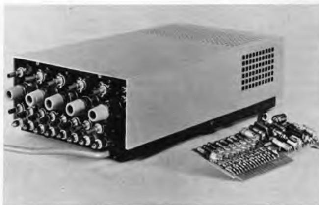
Bild 4. Der Kreuzschienenverteiler EL 8220 in der Schaltzentrale ist nicht mit Relais, sondern ausschließlich mit Transistoren bestückt
