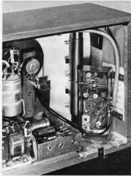
Rechts: Bild 5. Philips-Tischempfänger vom Typ Sagitta mit eingebauter Ferritantenne-Tuner-Einheit für UKW-Empfang
