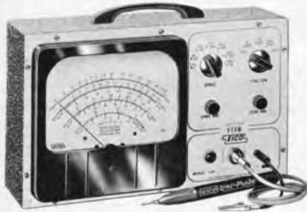
Röhrenvoltmeter 249 de Luxe mit umschaltbarem Tastkopf
