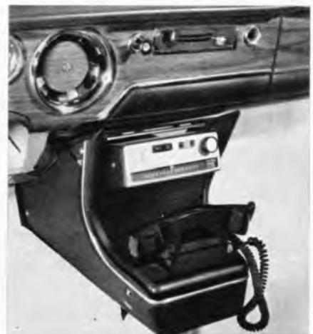
Bild 3. Bedienungsstück des Fahrzeug-Funksprechgerätes B 82 mit Selektivrufzusatz von TeKaDe. Der Sender/Empfänger wird im Kofferraum untergebracht (Aufn.: E. Schwahn)
