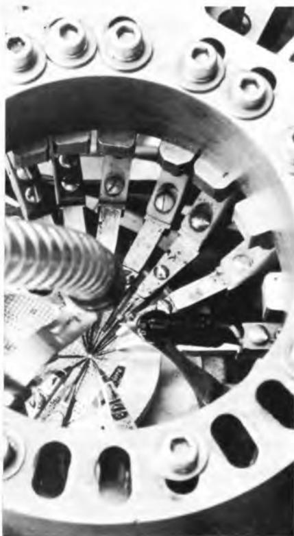
Bild 21. Der Meßplatz zur elektrischen Vorprüfung der integrierten Schaltungen auf der Siliziumscheibe
