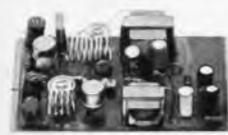
**KM 2/5 2-m-Sender mit Modulator**, quartzesteuert, 144,2 MHz oder 145 MHz. Sender 2stufig. Modulator mit Modulationsübertrager, getrennter 5- $\Omega$ -Ausgang f. Empfänger-Lautspr.,
