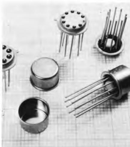
Bild 22. Die Einzelteile (Bodenplatte, Kappe) des Metallgehäuses für integrierte Schaltungen. Rechts ein zusammengesetztes Gehäuse
