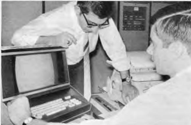
Links: Im geplanten deutschen Kontrollzentrum für Satellitenbeobachtung werden die vom Flugkörper zur Erde gesendeten Daten entsprechend aufbereitet und über einen Siemens-Prozeßrechner dekommutiert. Zur Ausgabe der Klartext-Daten dienen Protokolldrucker und Datensichtgeräte
